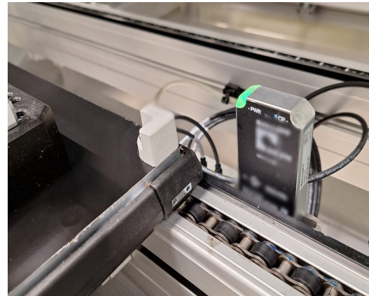
Slika 32. Senzor prisustva (paleta nije prisutna) i RFID
