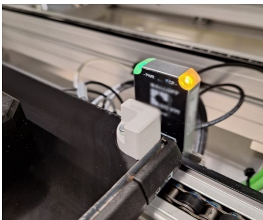
Slika 33. Senzor prisustva (paleta je prisutna), RFID identificira paletu
