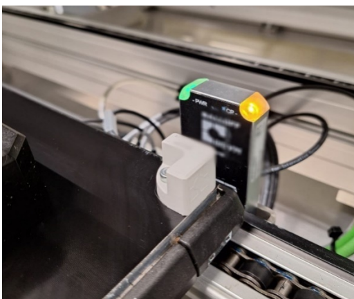
Slika 33. Senzor prisustva (paleta je prisutna), RFID identificira paletu
