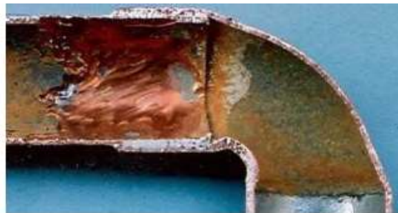
Slika 18. Erozijsko – korozivsko oštećenje bakrenog cjevovoda – oštećenja su usmjerena u smjeru protoka medija. [1]
