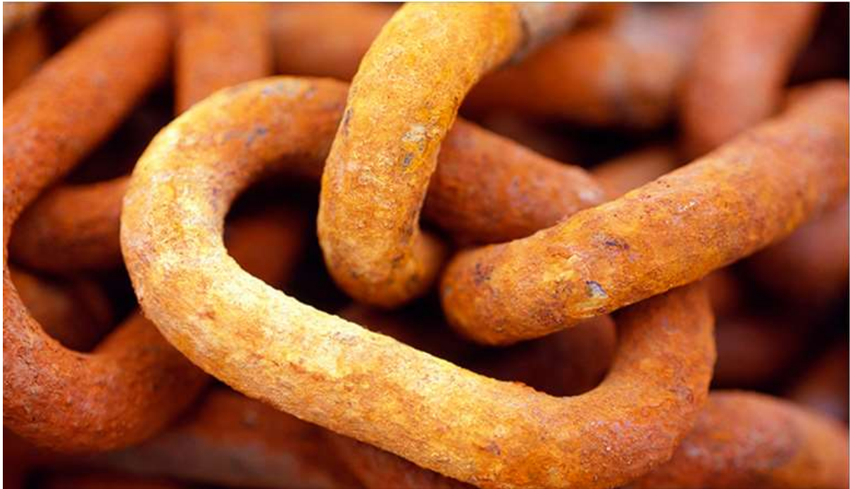
Slika 4. Korozija željeznog lanca. [6]
