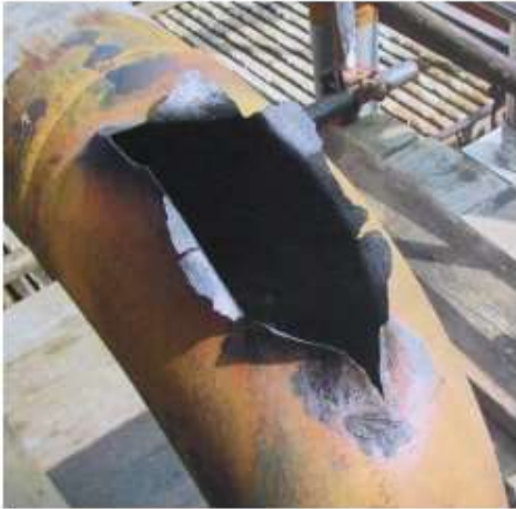
Slika 17. Posljedica erozijsko korozivskog oštećenja cjevovoda za transport nafte. [1]
