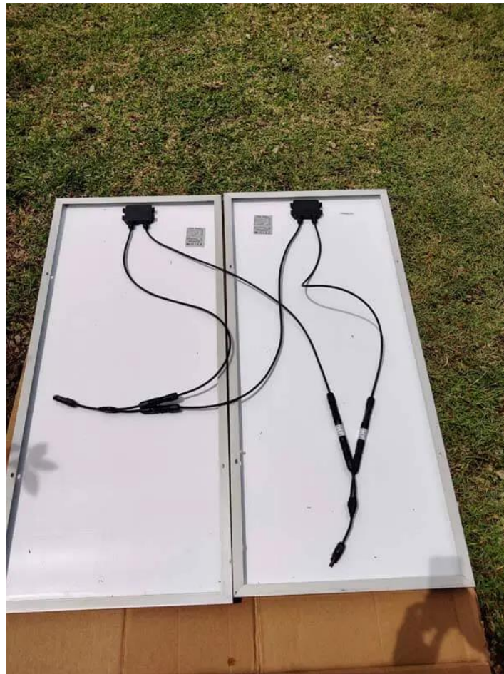
Slika 22. – Fizički prikaz solarnih panela spojenih u paralelu
