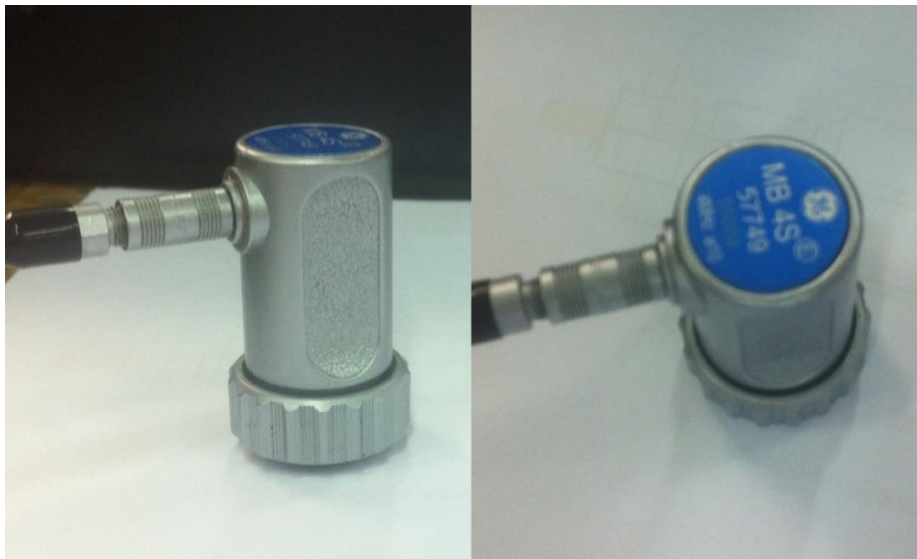
Slika 11.2. Ravna sonda MB 4S
