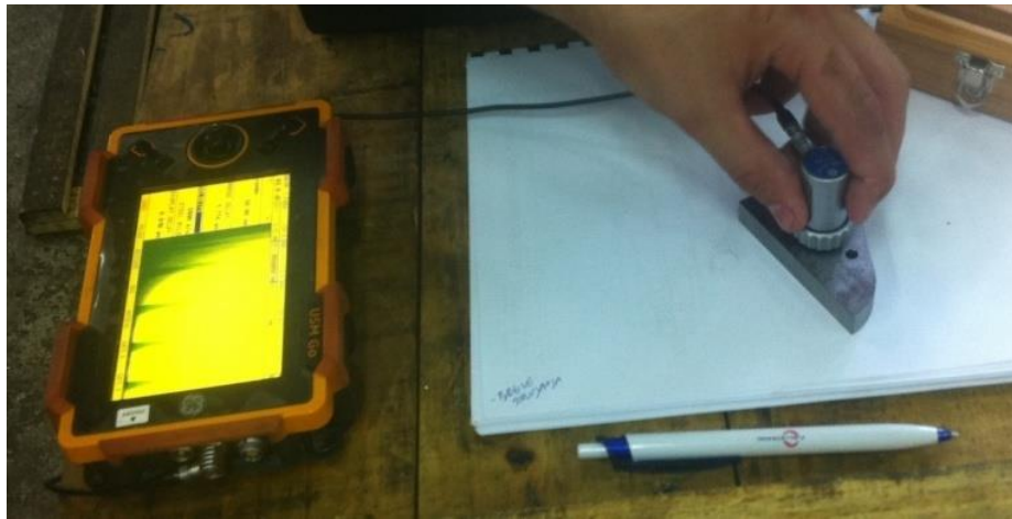
Slika 11.8. Baždarenje sonde na BD= 12.5 mm MP=50mm
