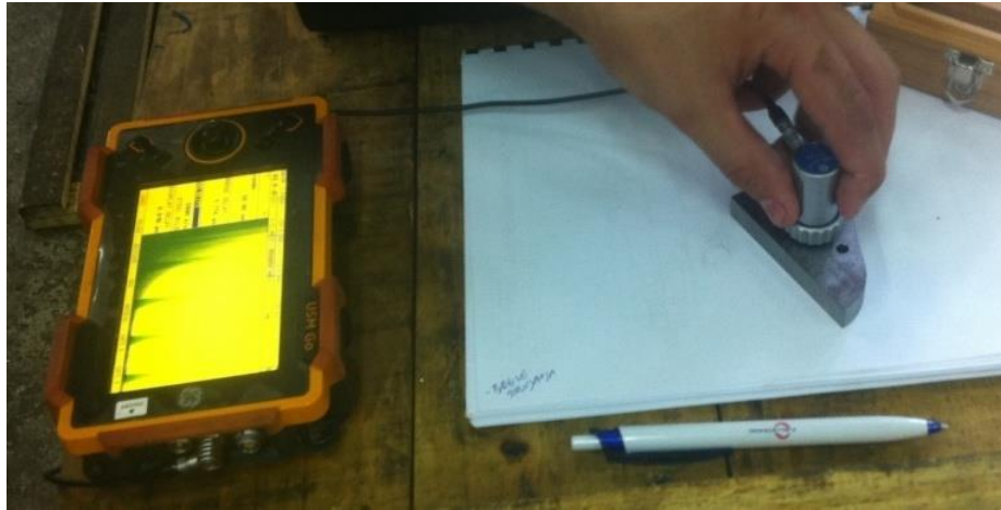
Slika 11.8. Baždarenje sonde na BD= 12.5 mm MP=50mm
