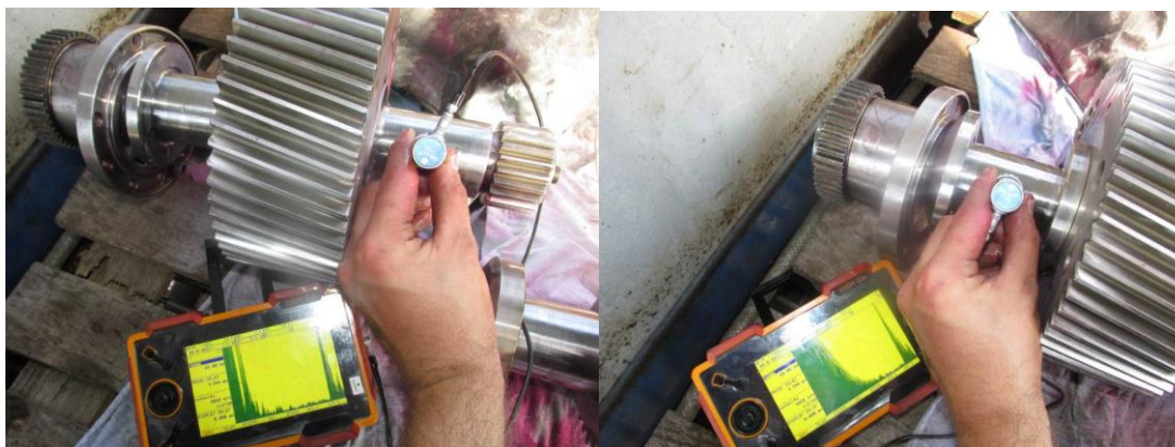
Slika 11.10. Ispitivanje ležajnih rukavaca kod pogonskog zupčanika
