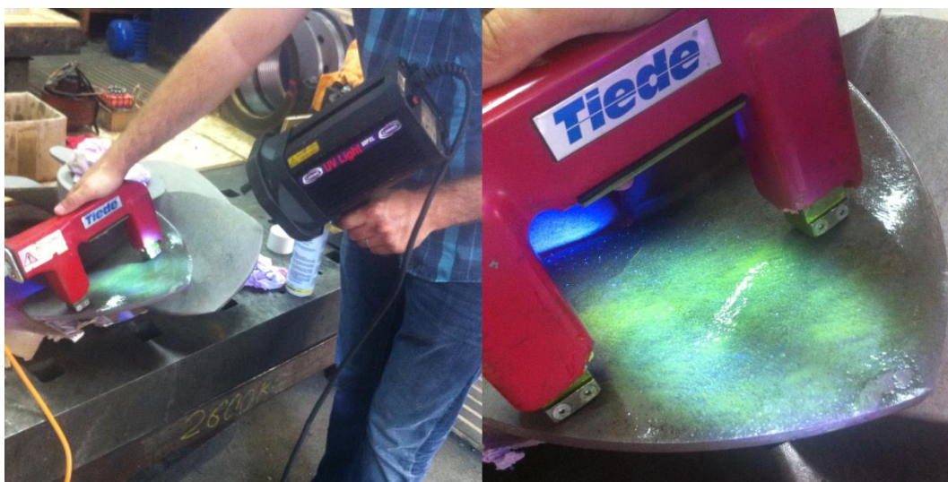
Slika 2.3. Ispitivanje magnetskim česticama
