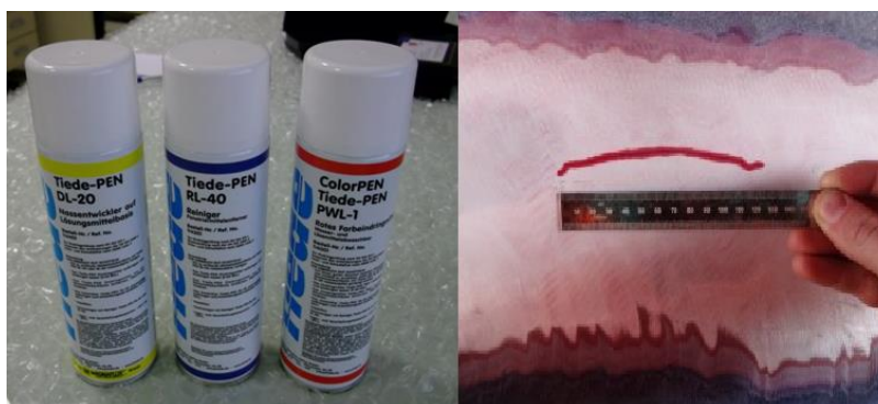
Slika 2.2. Ispitivanje penetrantima: razvijatelj, čistač i penetrant (lijevo) penetrantska indikacija (desno)
