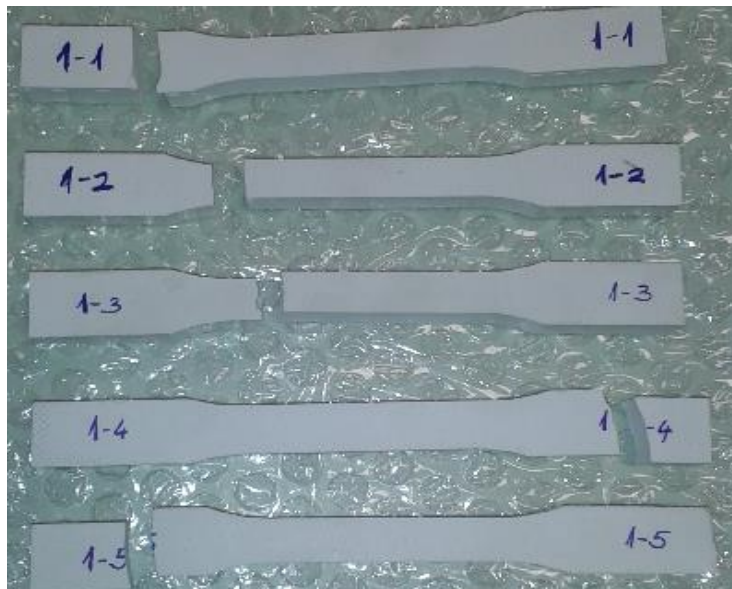
Slika 58. Astone nakon puknuća
