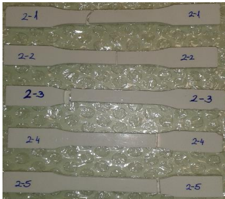
Slika 59. Akril ojačan staklenim vlaknom nakon ispitivanja
