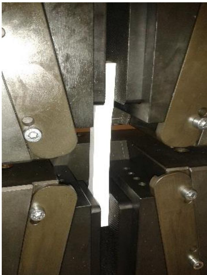
Slika 57. Pravilno postavljanje epruvete
