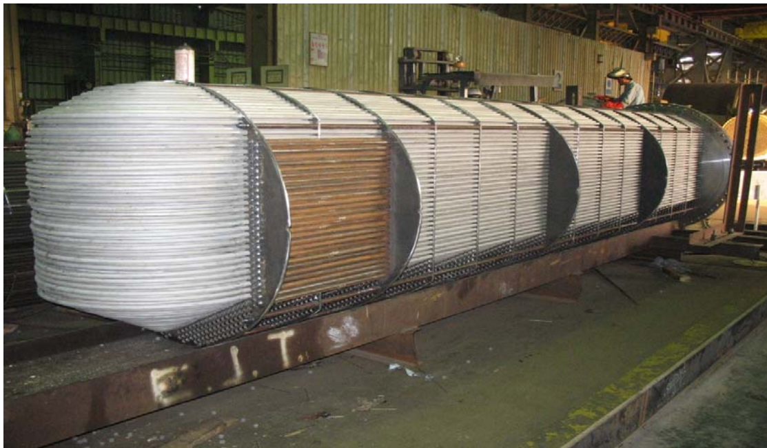
Slika 43. „Shell and tube“ izmjenjivač u proizvodnji
