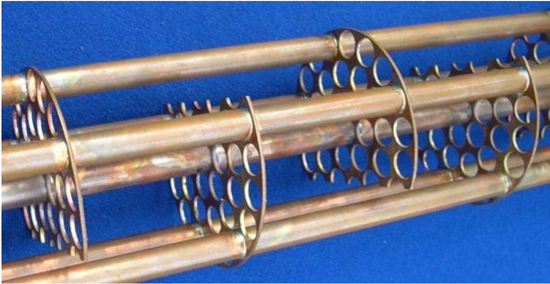
Slika 44. Pregrade u izmjenjivaču topline
