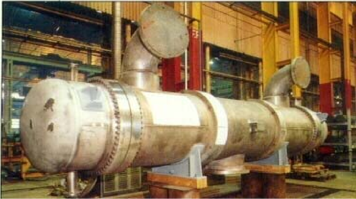
Slika 48. Gotova konstrukcija „Shell and tube“ izmjenjivača topline
