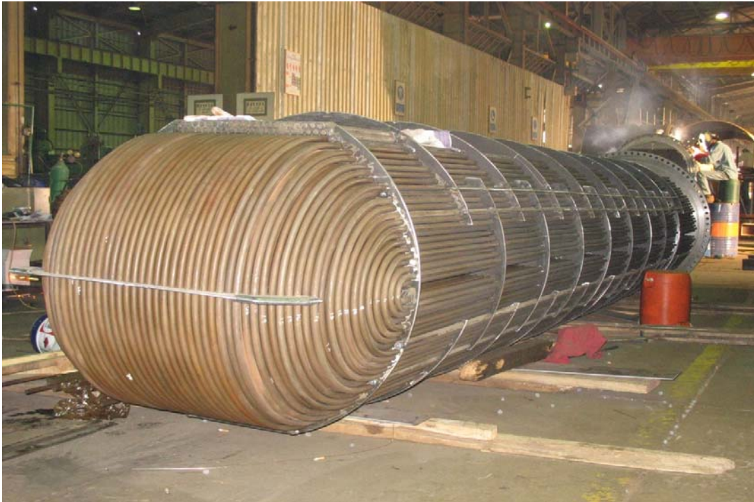
Slika 42. „Shell and tube“ izmjenjivač u proizvodnji
