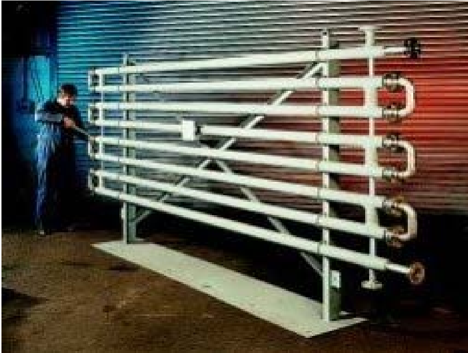
Slika 38. Izmjenjivač topline s dvostrukom cijevi
