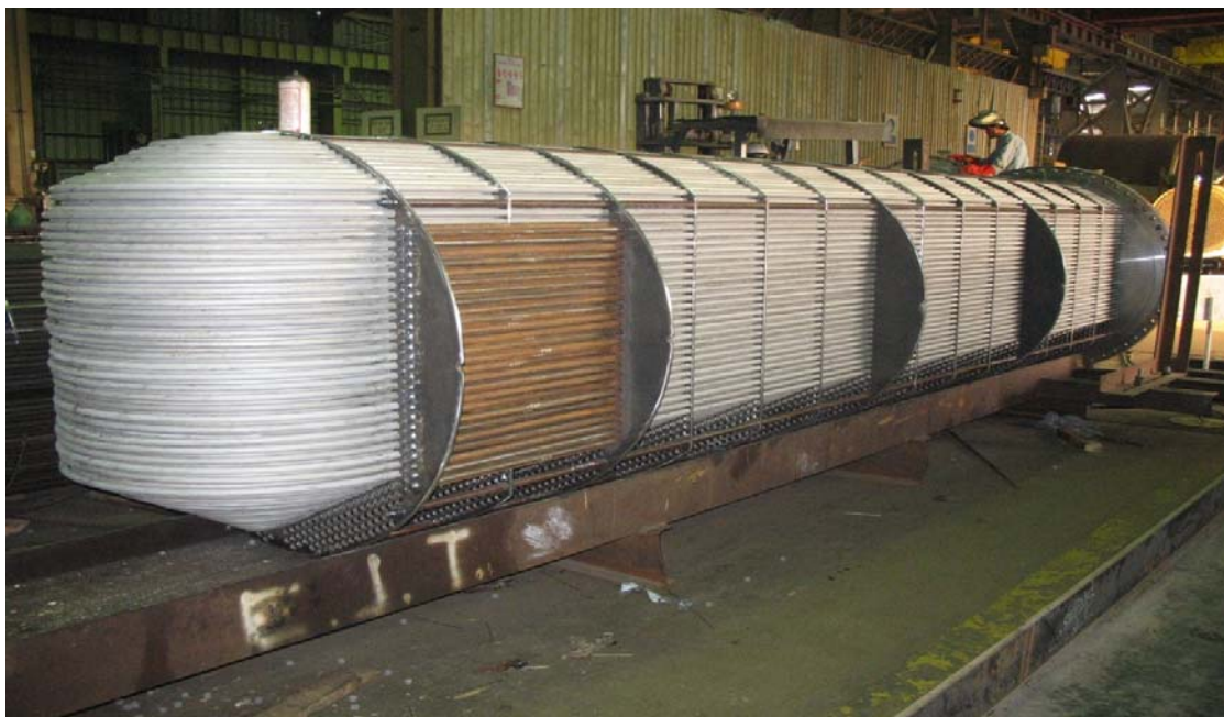
Slika 43. „Shell and tube“ izmjenjivač u proizvodnji
