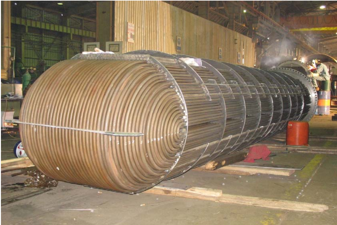
Slika 42. „Shell and tube“ izmjenjivač u proizvodnji
