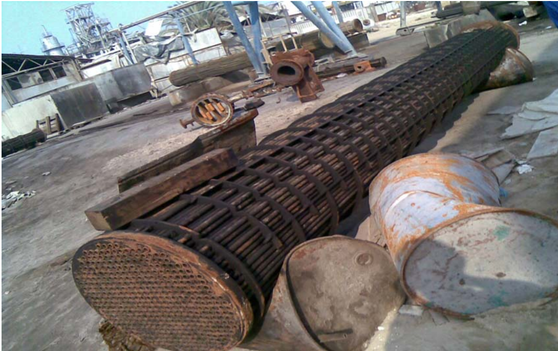
Slika 41. „Shell and tube“ izmjenjivač
