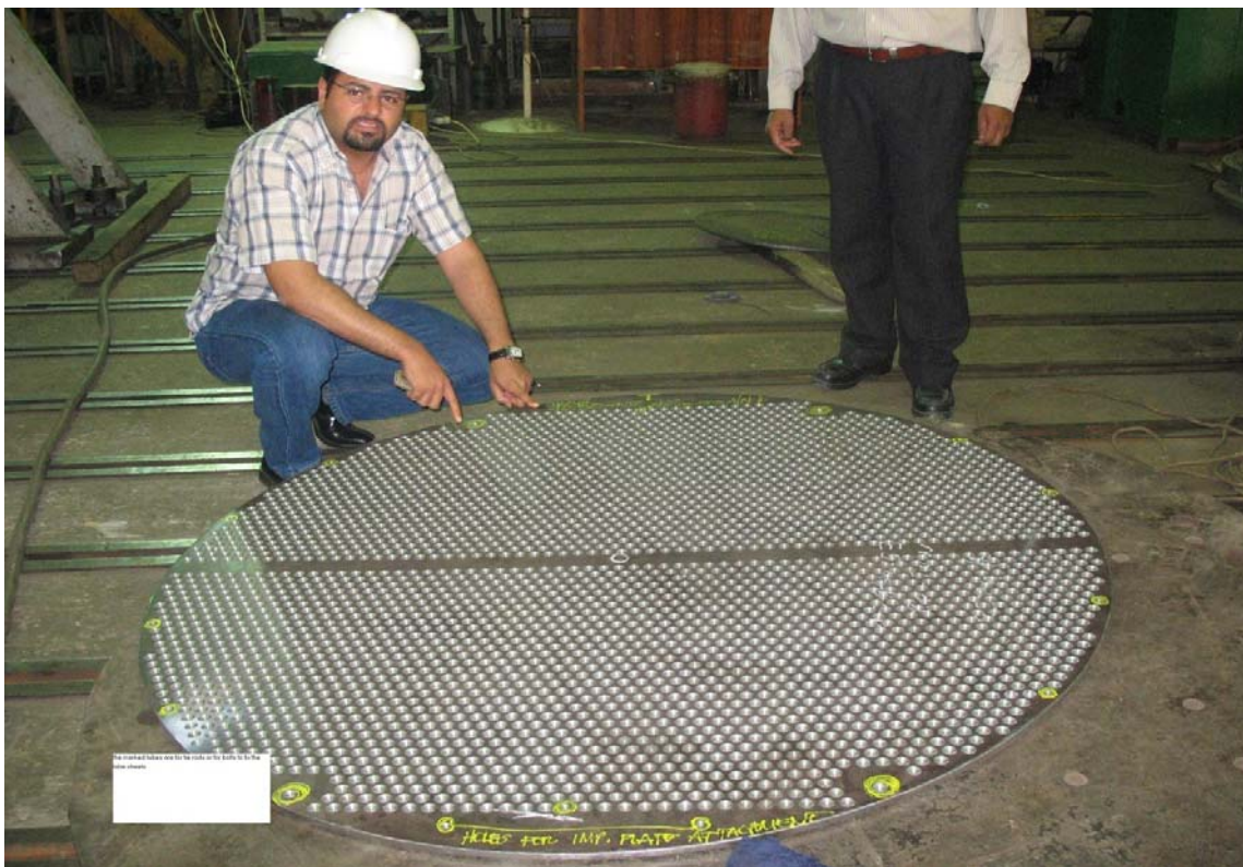
Slika 46. Postupak bušenja razdjelne ploče
