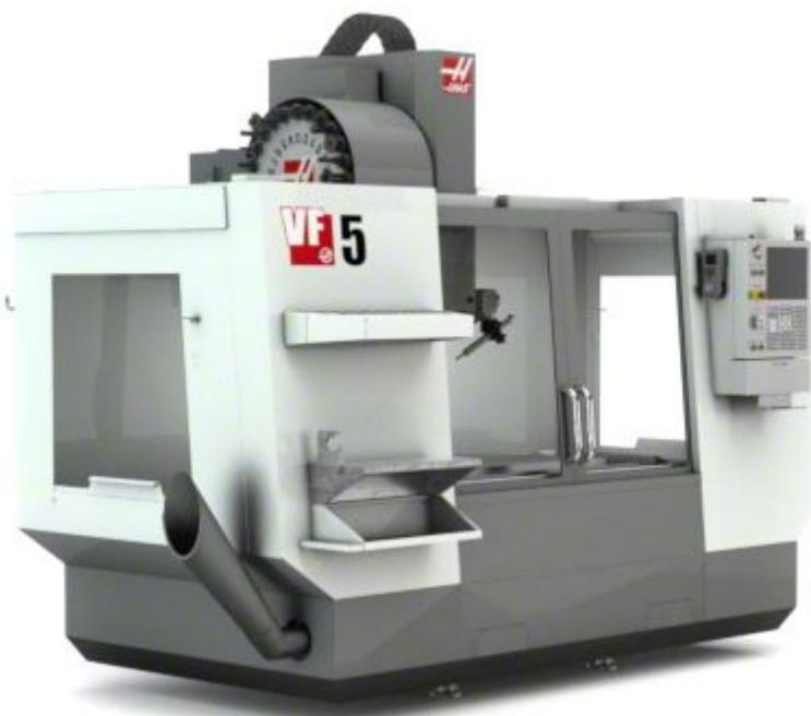
Slika 18. HAAS VF-5/40 obradni centar
