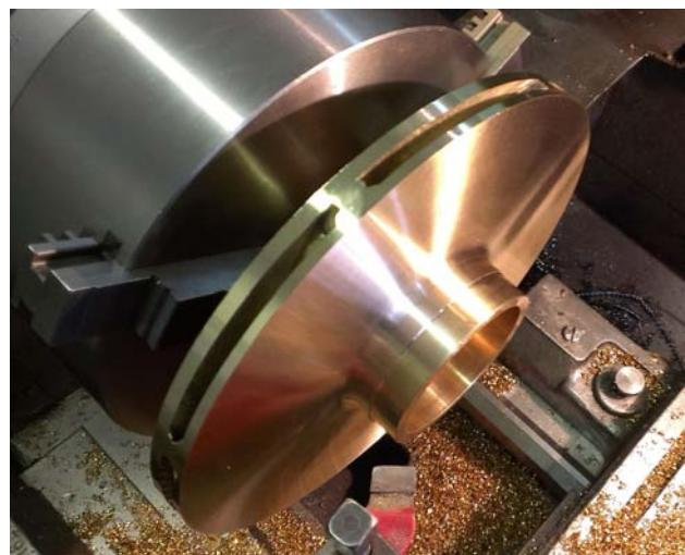
Slika 55. Obrada na tokarskom stroju
