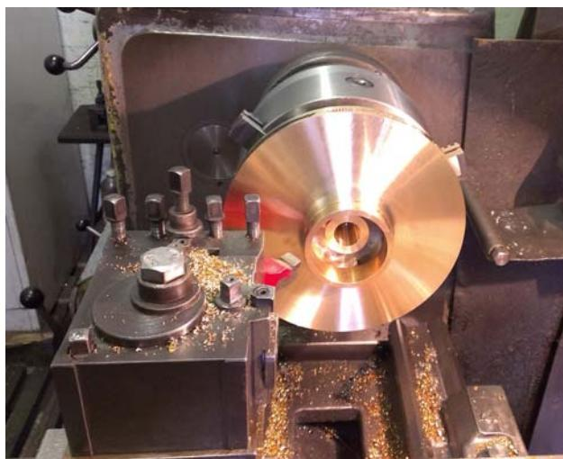
Slika 54. Obrada na tokarskom stroju
