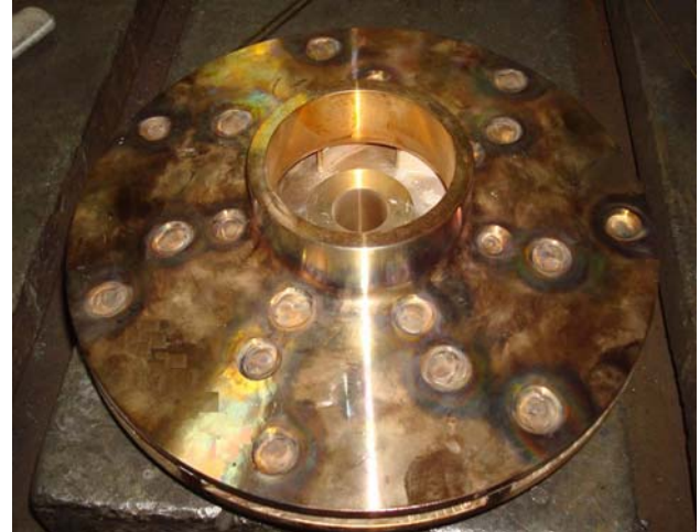
Slika 53. Rotor nakon zavarivanja
