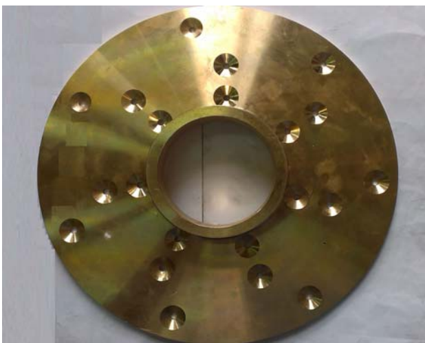
Slika 48. Zabušivanje diska s vanjske strane
