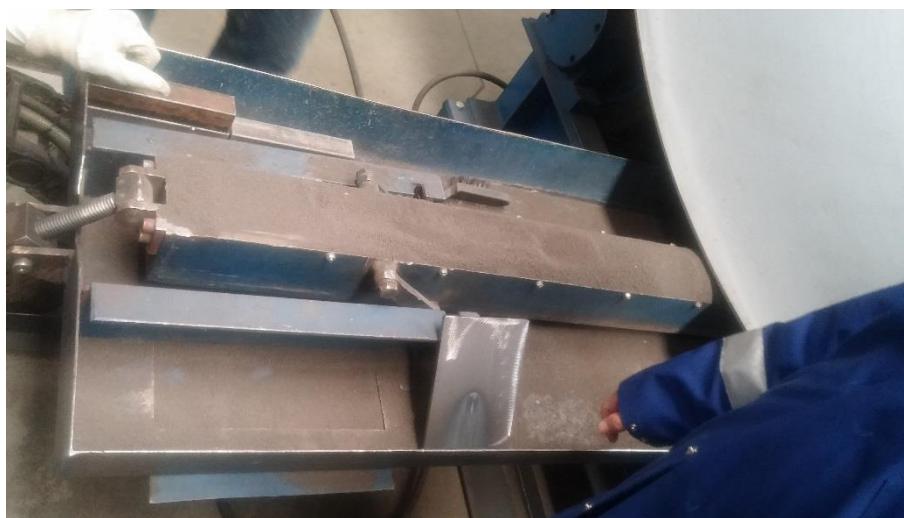
Slika 13. Nečistoća na uređaju za okretanje oplate
