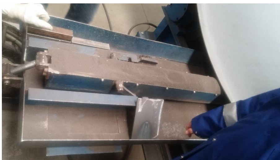
Slika 13. Nečistoća na uređaju za okretanje oplate
