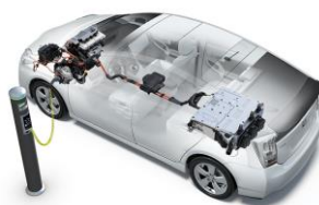
Slika 3.12. Koncept punjenja električnog vozila.
