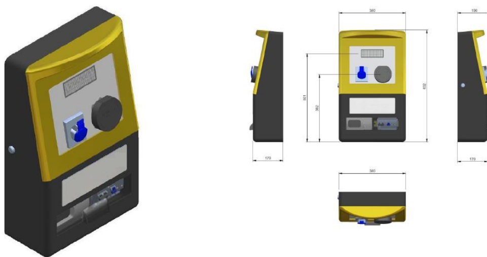
Slika 6.1. Samostojeća punionica za električna vozila
