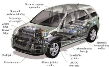
Slika 4.3. Shema sistema rada vozila na vodik.
