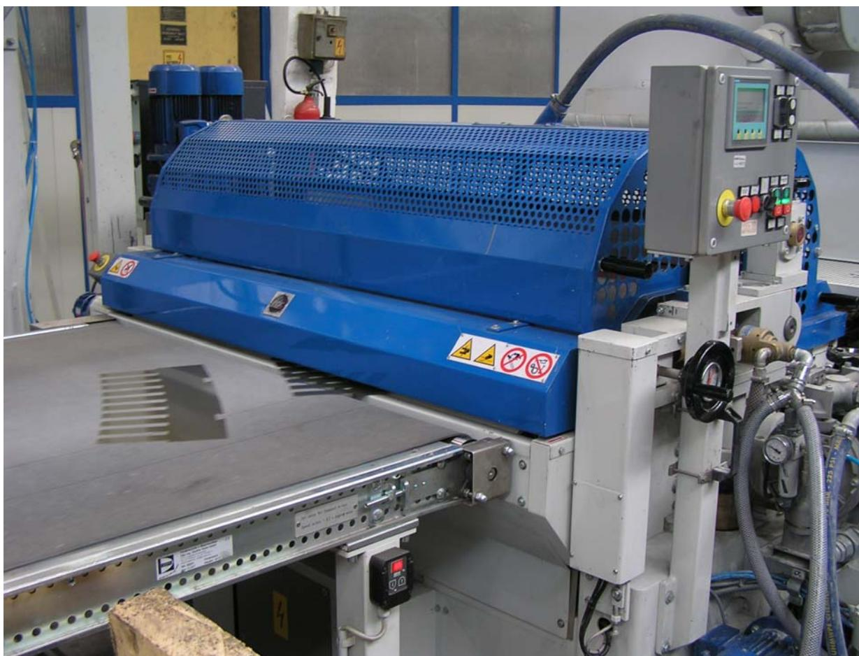
Slika 29. Uređaja za nanošenje laka (Tomanin) [9]
