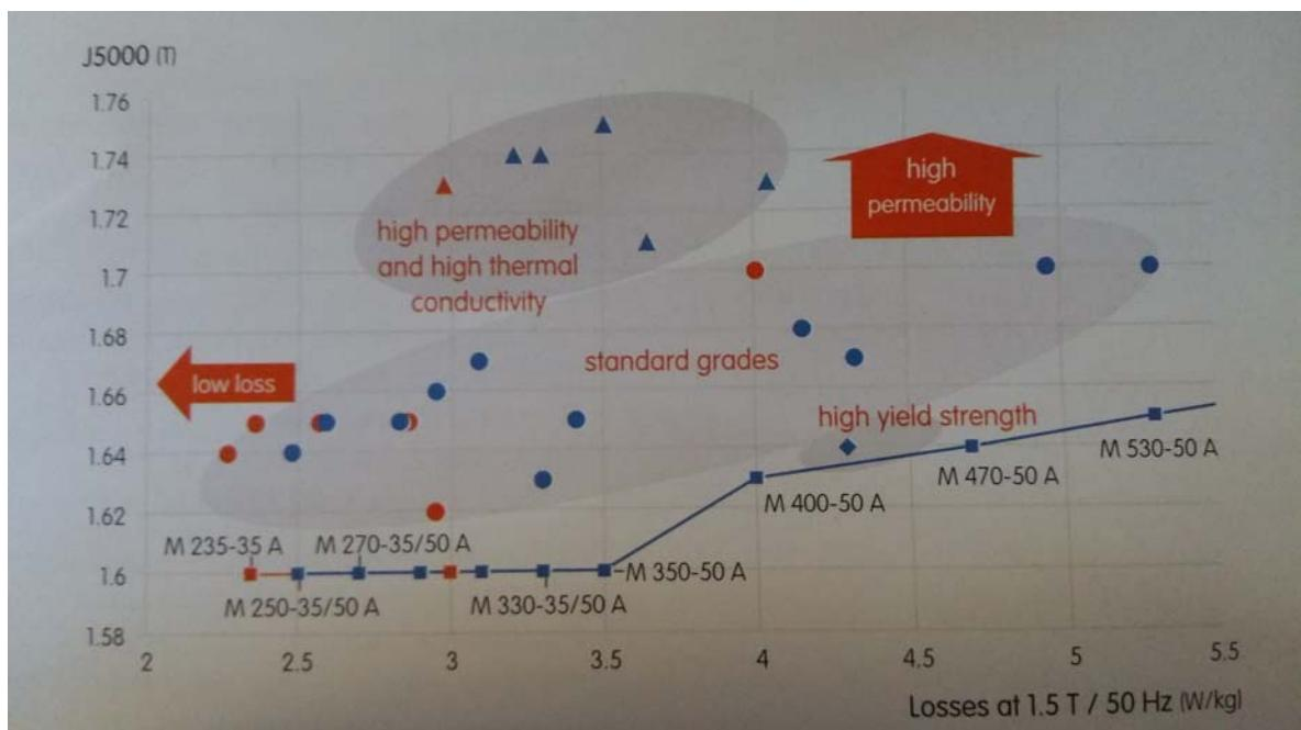
Slika 19. Odnos permeabilite i gubitaka pojedinih kvaliteta feromagnetskog lima za vrijednost 1.5T [12].
