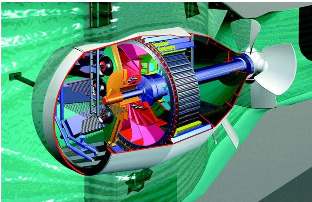
Slika 1. Primjer cijevnog hidrogeneratora s turbinom uronjenog u tok vode [4]
