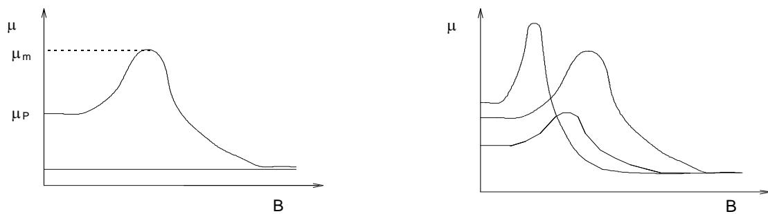
Slika 4. Ovisnost permeabiliteta o magnetskoj indukciji [6]
