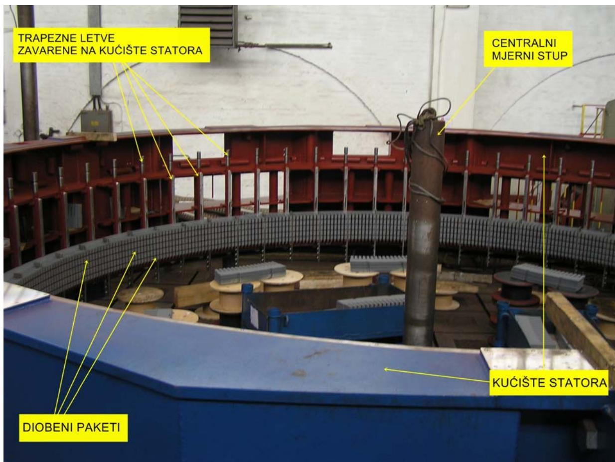
Slika 10. Kućište statora s osnovnim dijelovima [9]
