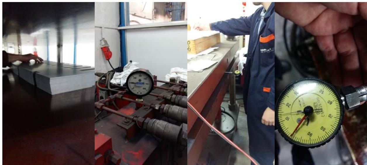
Slika 32. Slaganje limova u prešu, tlačenje limova, i mjerjenje rastojanja ploča preše [9]
