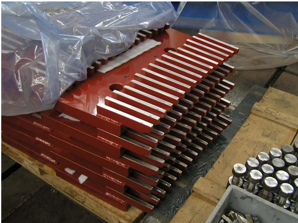
Slika 8. Segmentne tlačne ploče [9]
