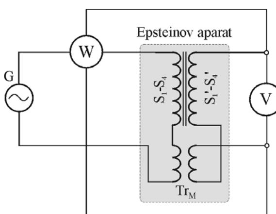
Slika 22. Vatmetrička metoda mjerena gubitaka u magnetskim limovima [13]
