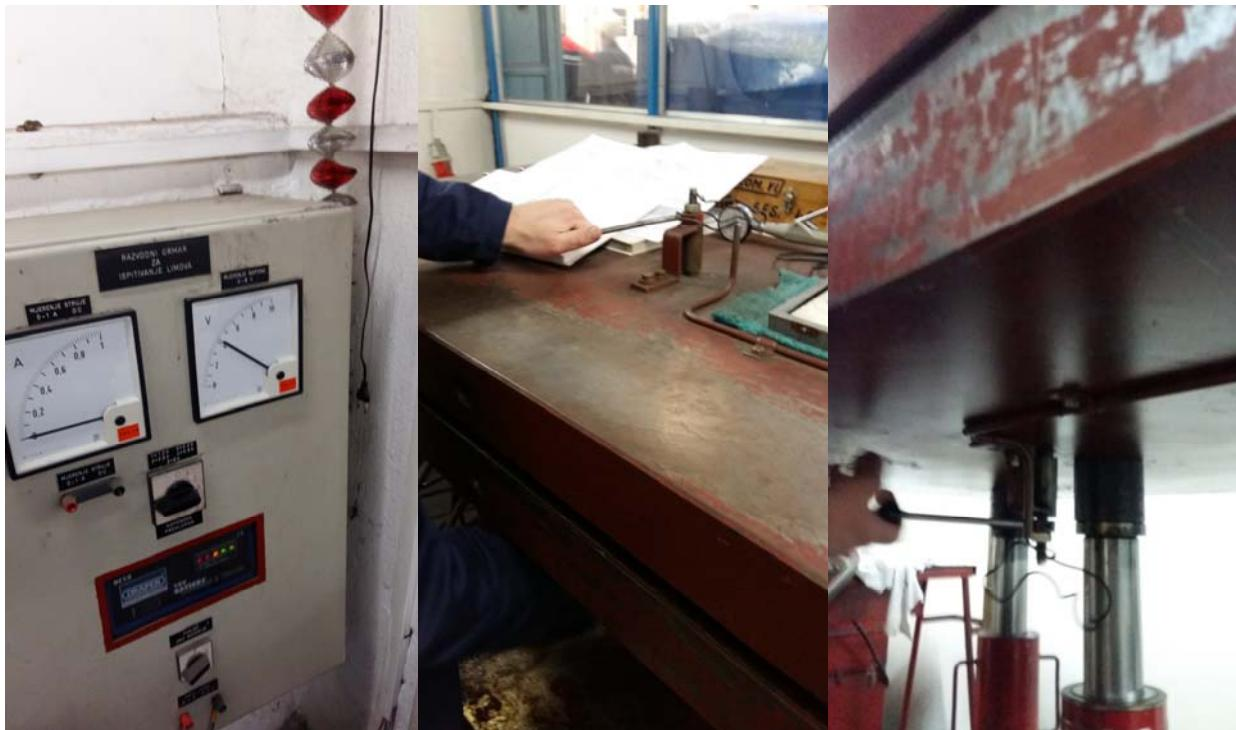
Slika 36. Razvodni ormari za postupak mjerjenja limova, te gornji i donji „šiljak“ na pločama preše [9]
