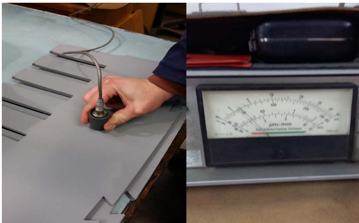
Slika 30. Mjerena debljina izolacionog laka na statorskom segmentnom limu LEPTOSKOPOM [9]
