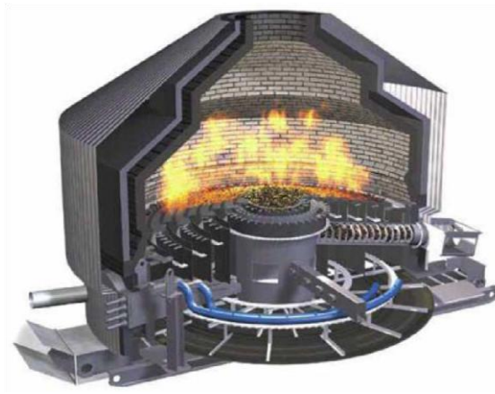
Slika 14. Rotirajuća konična rešetka s donjim dovodom goriva
