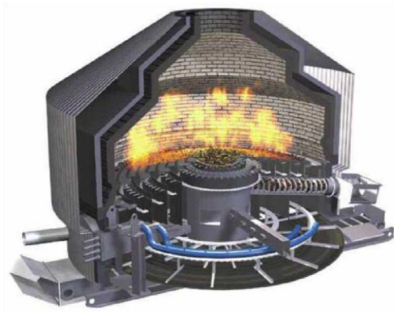
Slika 14. Rotirajuća konična rešetka s donjim dovodom goriva
