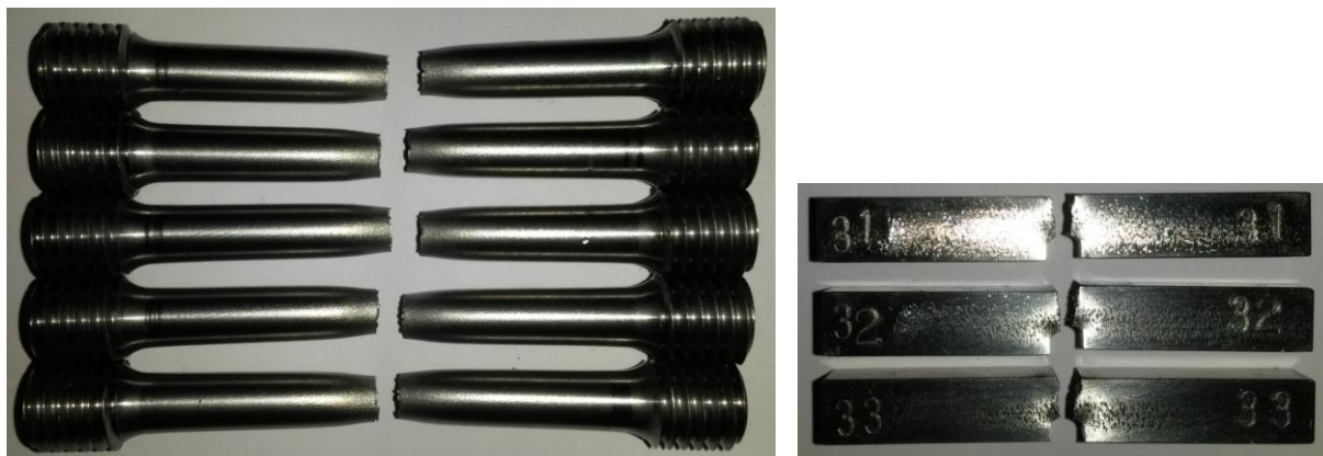
Slika 47 – Uzorci iz materijala Č4230 nakon: a) statičkog vlačnog pokusa b) udarnog rada loma
