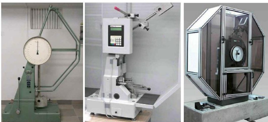
Slika 22 – Primjeri uređaja Charpy-evog bata [13]
