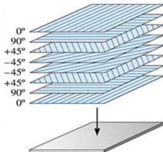
Slika 14. Laminati sa različito orijentiranim vlaknasto ojačanim slojevima [19]
