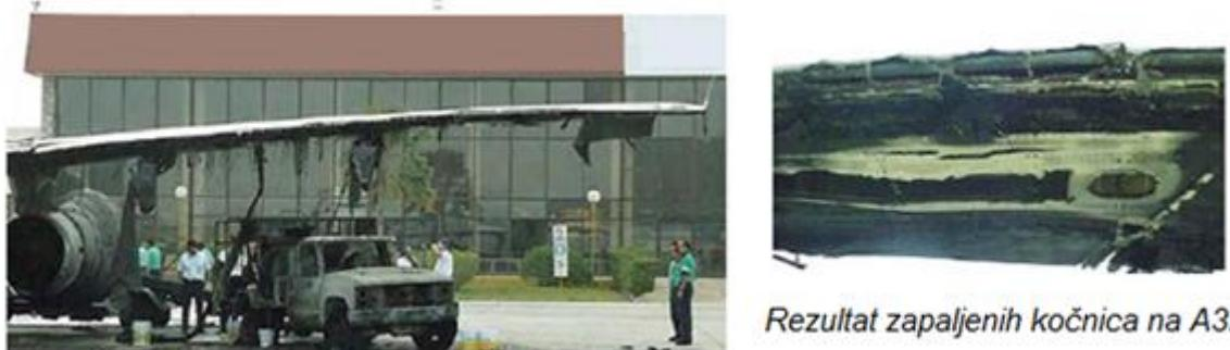
Rezultat zapaljenih kočnica na A320
