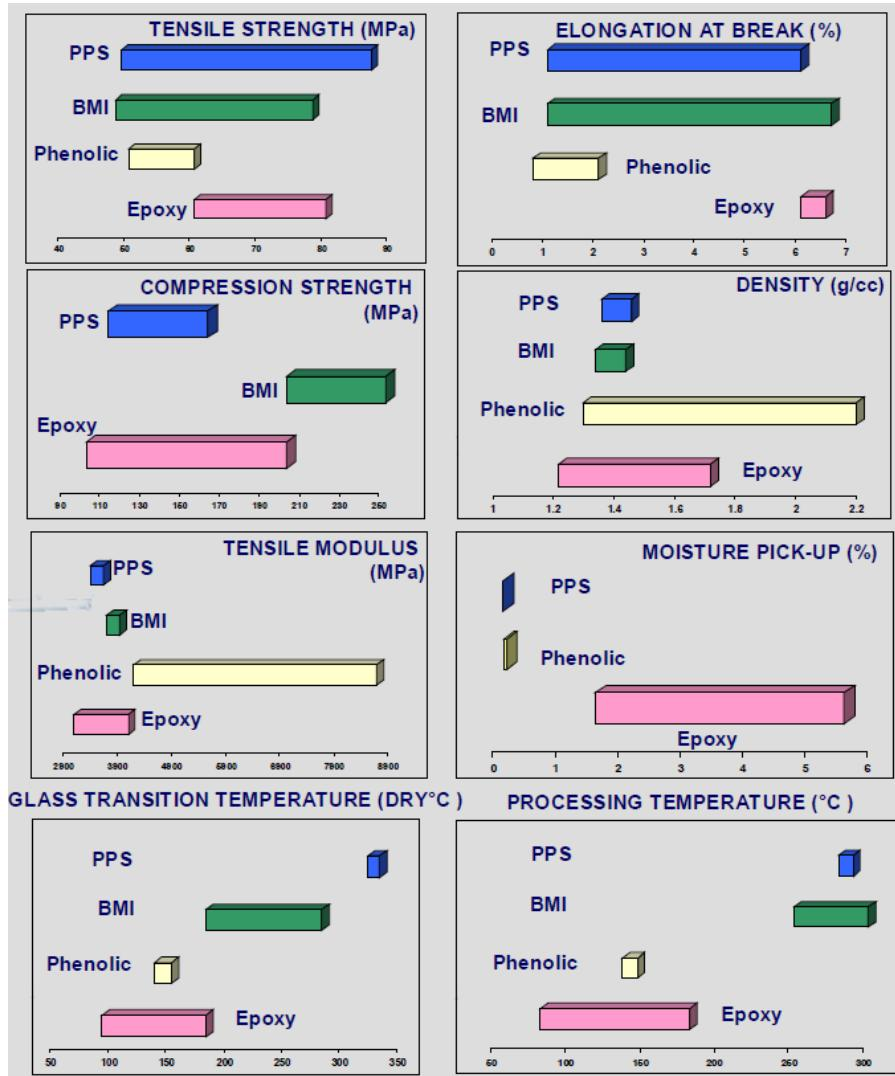
Slika 30. Pregled svojstava matrica primjenjivih u zrakoplovim konstrukcijama [3]
