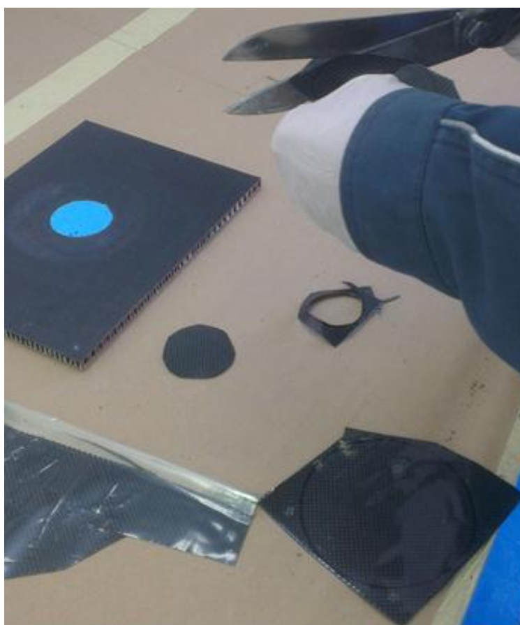
Slika 70. Rezanje drugog i trećeg sloja
