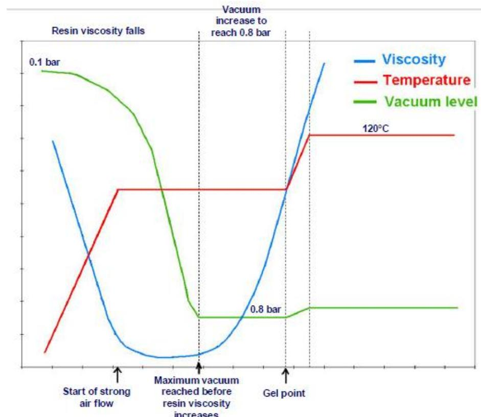
Slika 82. Veza temperature, viskoznosti smole i vakuumskog pritiska.
