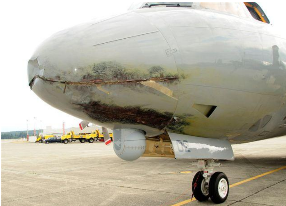
Slika 19. Oštećenje na zrakoplovu nakon udara munje [21]
