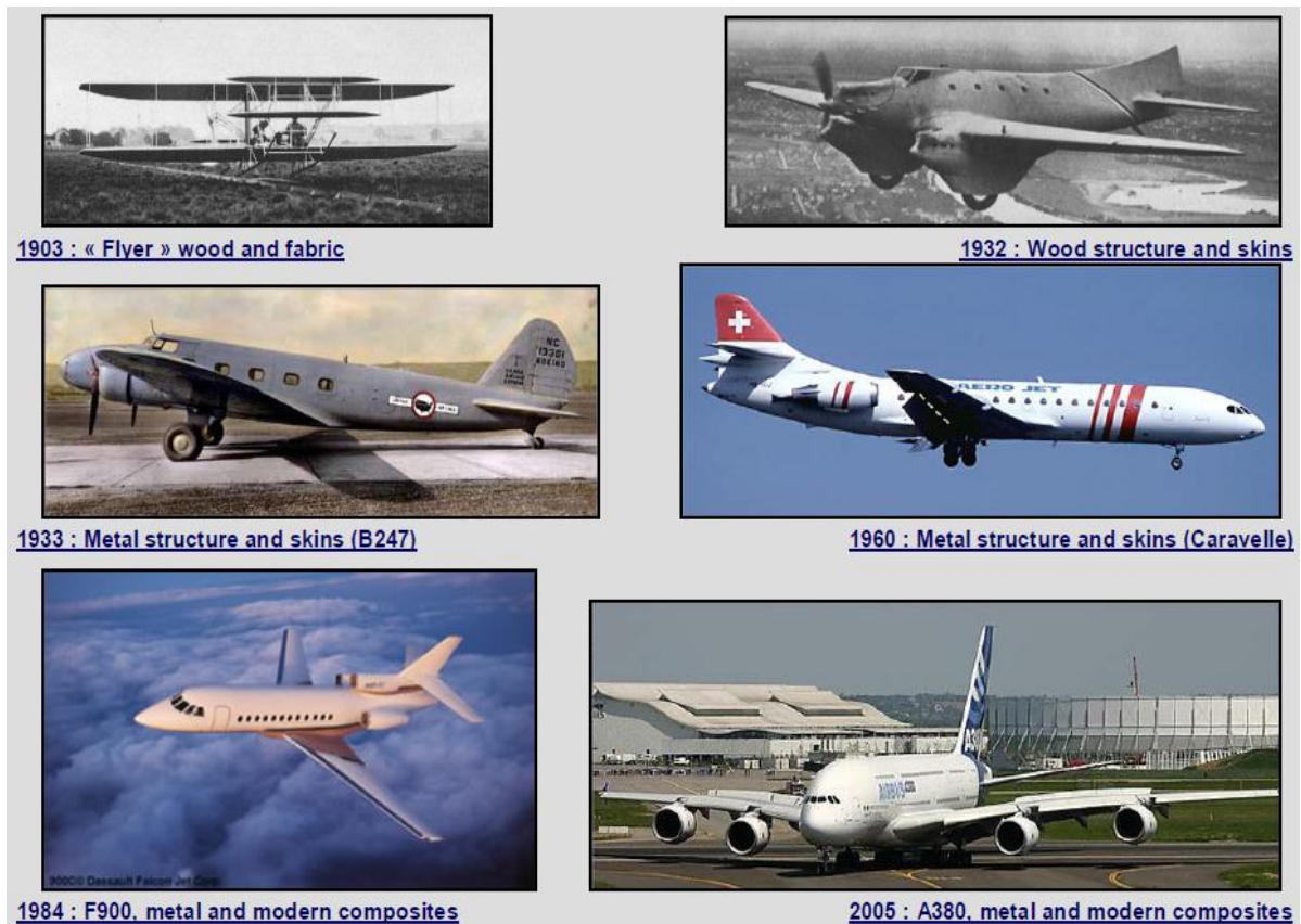
Slika 20. Kronološka primjena materijala u strukturi zrakoplova [3]
