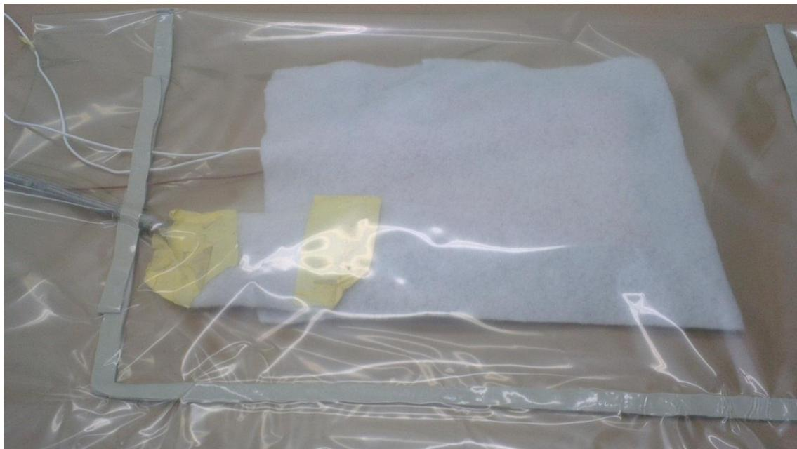
Slika 77. Vakuumiranje podnog zrakoplovnog panela
