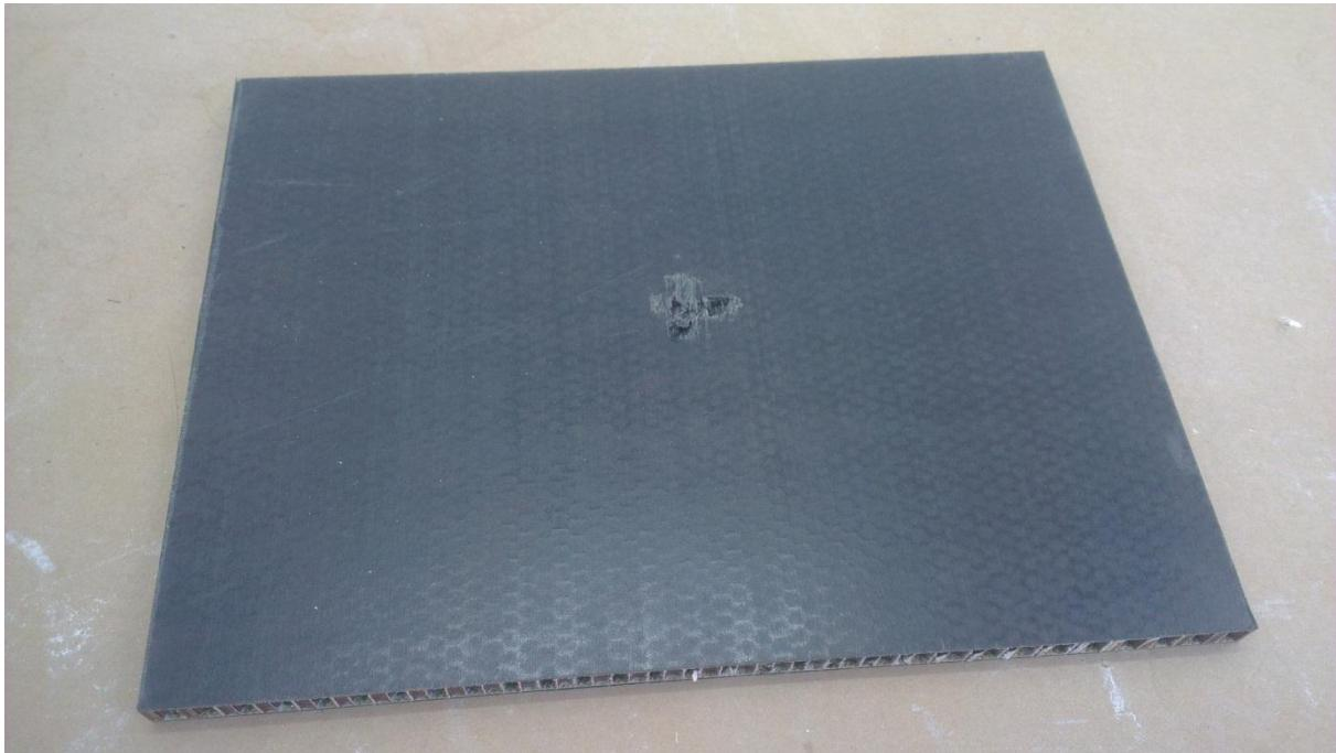
Slika 51. Uzorak podnog panela u zrakoplovu
