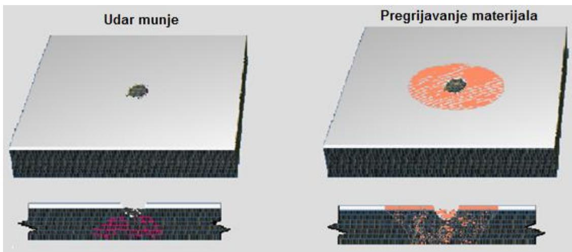
Slika 48. Oštećenja nastala djelovanjem udara munje i pregrijavanjem [3]
