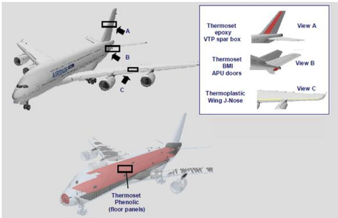
Slika 29. Podni paneli zrakoplova građeni od fenolne smole [3]
