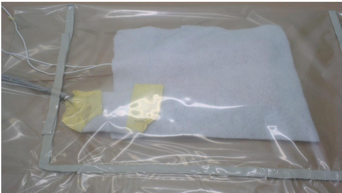
Slika 77. Vakuumiranje podnog zrakoplovnog panela
