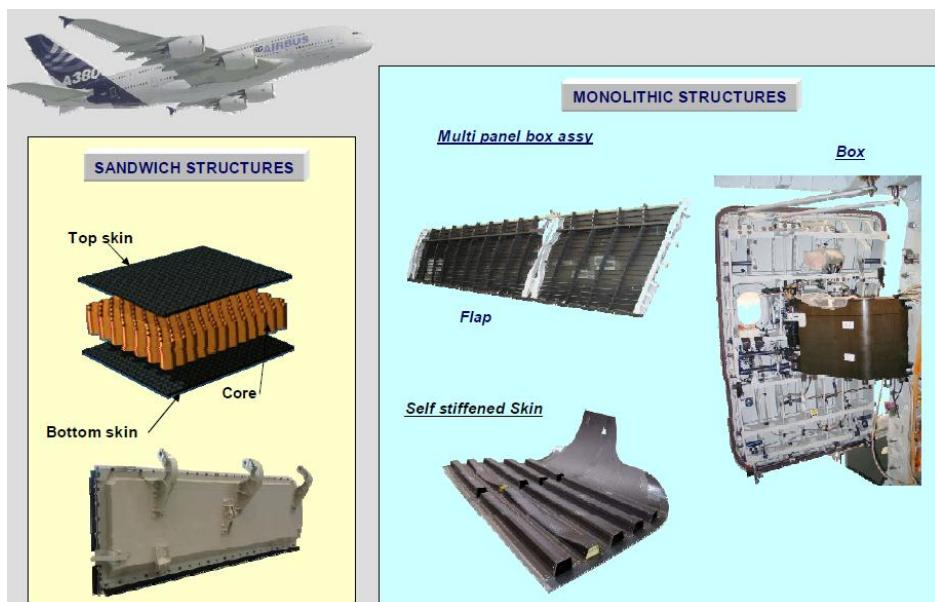
Slika 31. Vrste složenih kompozita u strukturi zrakoplova [3]
