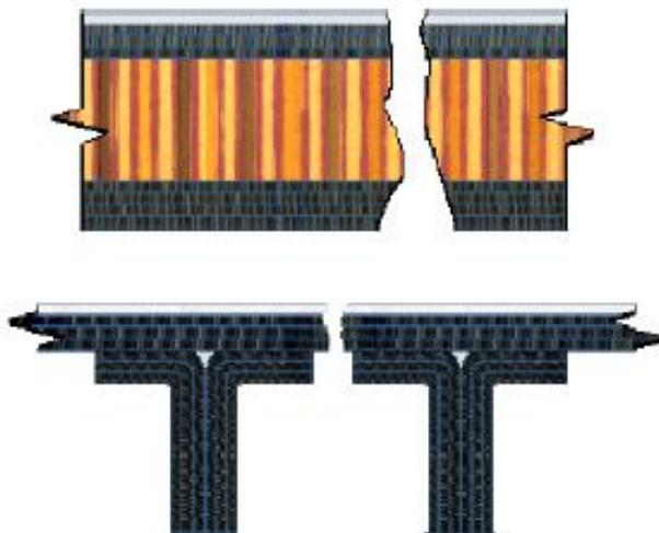
Slika 45. Oštećenja kod probijene sendvič i laminatne strukture
