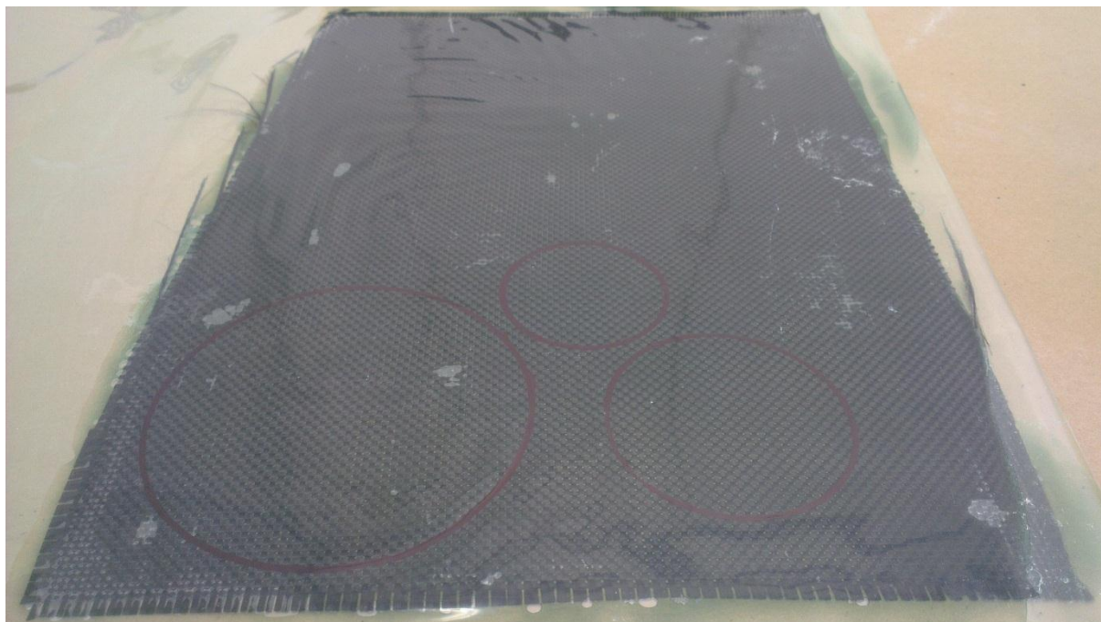
Slika 68. Označeni slojevi za rezanje
