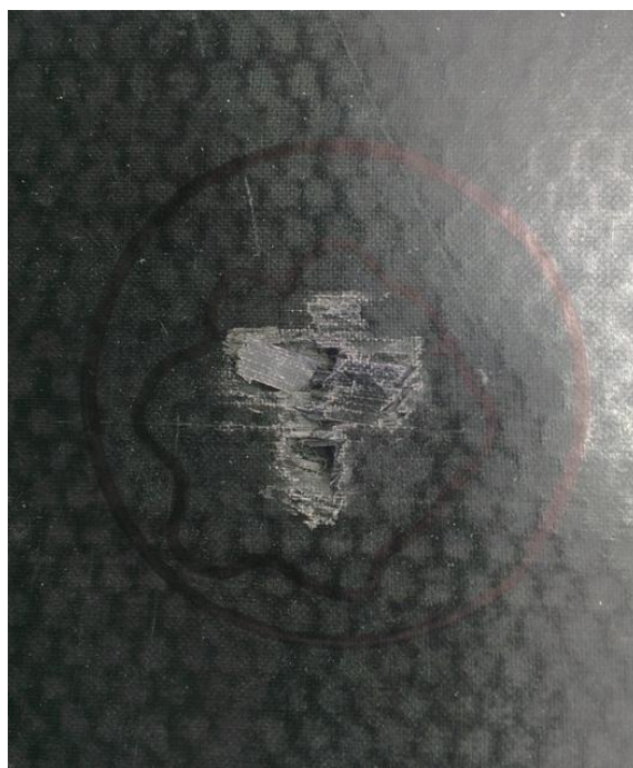
Slika 54. Područje odstranjivanja površinskog sloja
