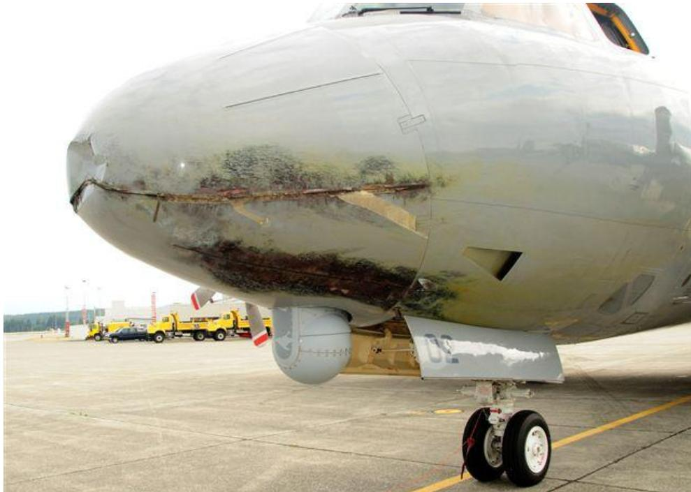
Slika 19. Oštećenje na zrakoplovu nakon udara munje [21]
