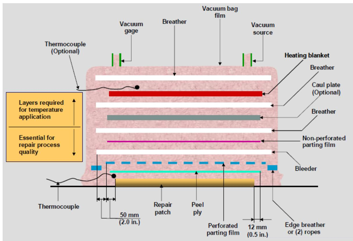
Slika 72. Presjek vreće za vakuumiranje i skrućivanje
