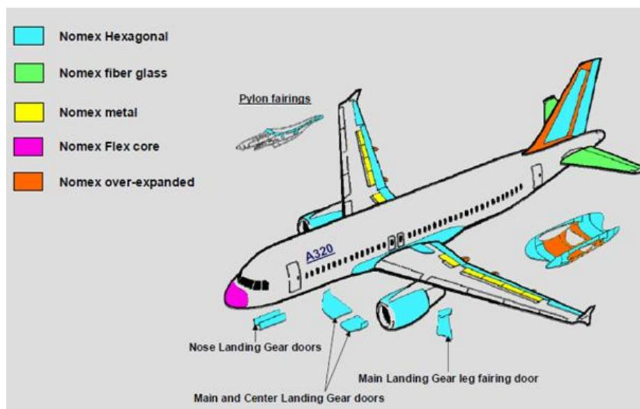
Slika 37. Primjena Nomex jezgara u zrakoplovnoj konstrukciji [3]
