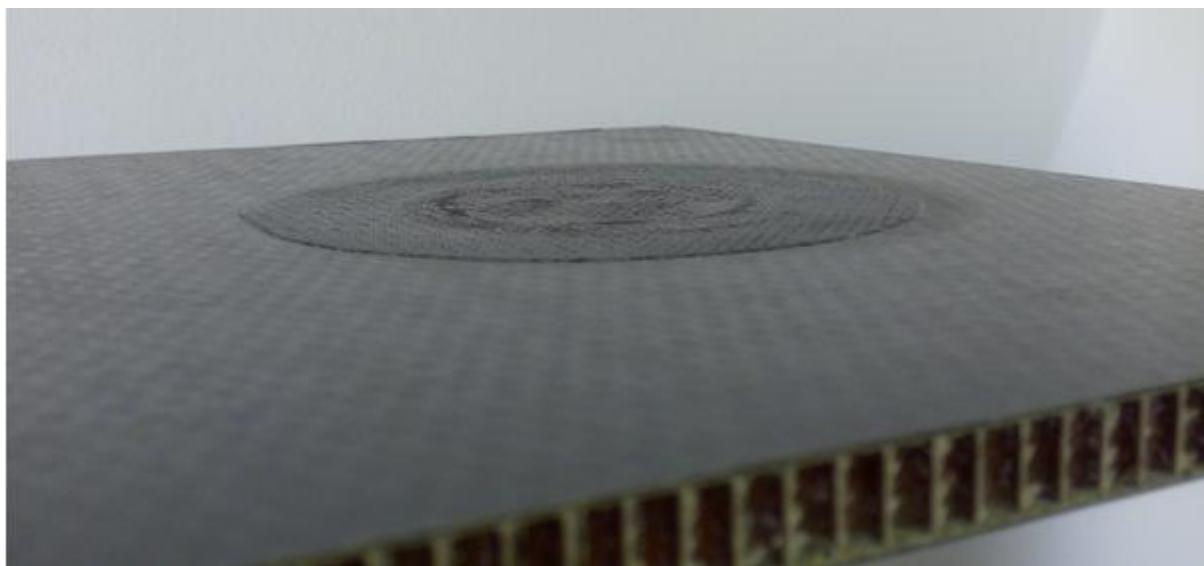
Slika 88. Vidljivi dijelovi popravka na mjestima spajanja
