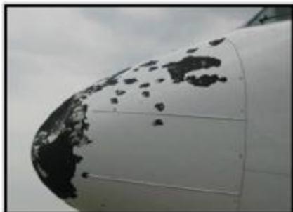
Oštećenje od tuče
