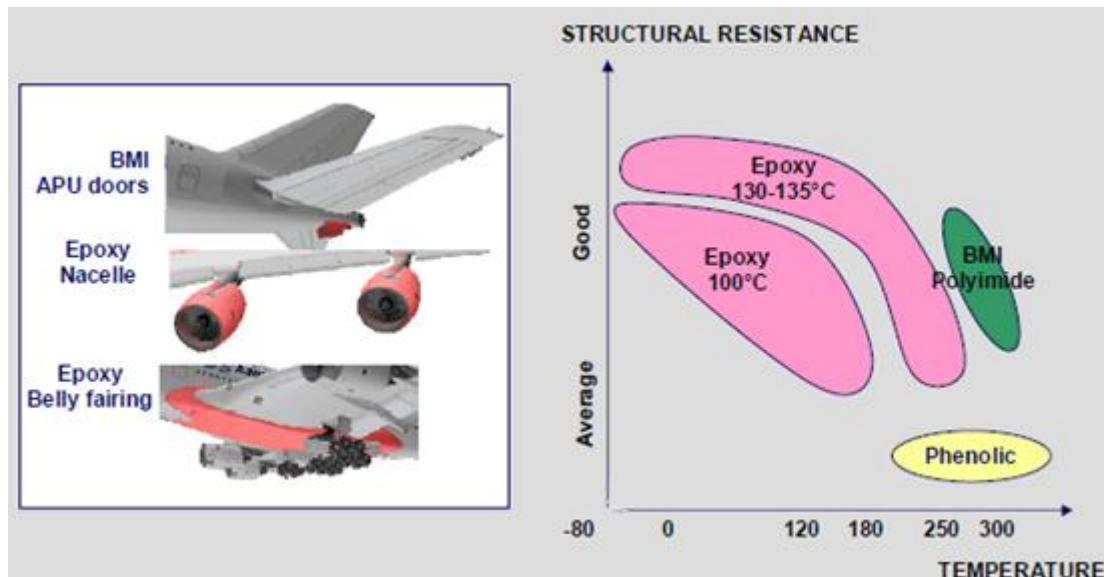
Slika 27. Primjena toplinsko stabilnih epoksida i BMI za izradu zrakoplovnih komponenata [3]
