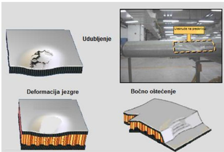
Slika 43. Djelovanje udarca i pritiska na složene kompozite [3]
