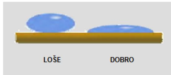
Slika 58. „Water break test“
