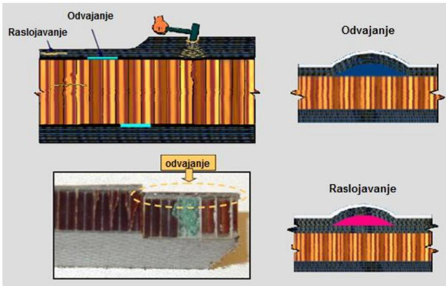
Slika 44. Raslojavanje i odvajanje kod sendvič konstrukcija [3]
