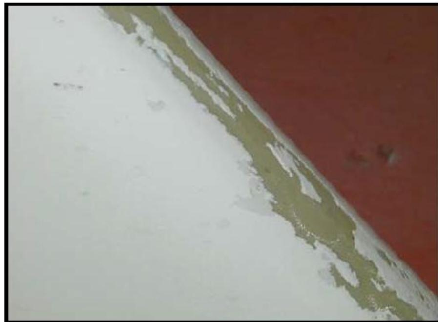
*Slika 49. Erozija na vertikalnom stabilizatoru [3]*
