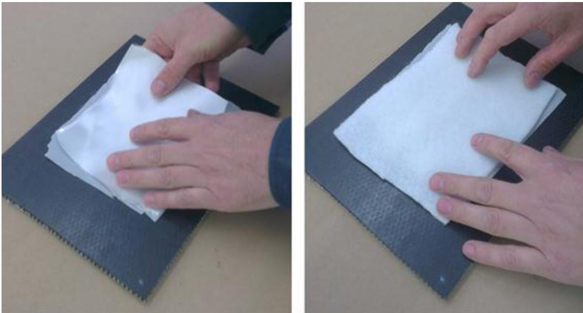
Slika 75. Nanošenje ostalih slojeva vakuumske vrećice.
