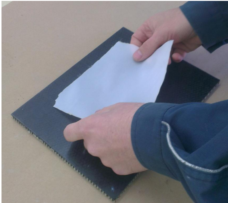
Slika 73. Nanošenje abrazivne tkanine
