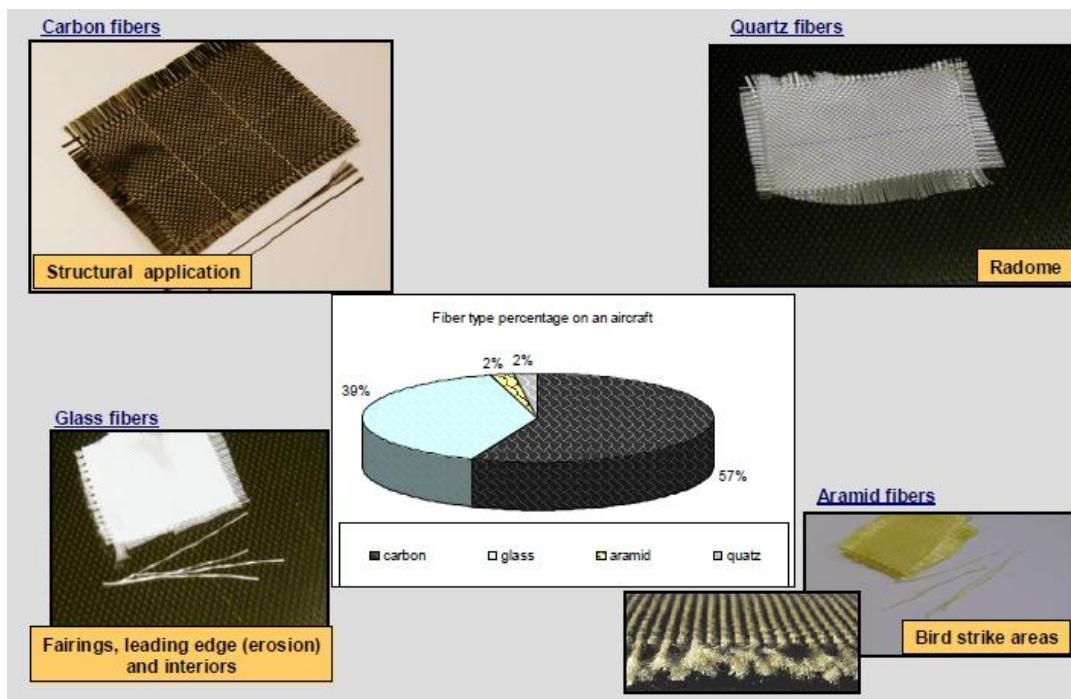
Slika 24. Vrste, udio i primjena vlakana u avionskoj konstrukciji [3]
