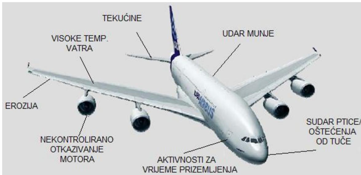
Slika 38. Uzroci oštećenja zrakoplovne konstrukcije
