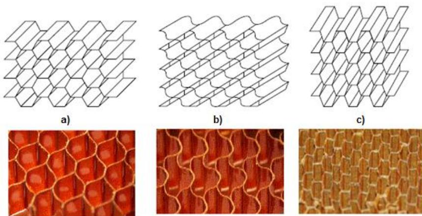
Slika 35. Oblici saćastih čelija: a) šesterokutne, b) „flex-core“ i c) pravokutne [22,3]
