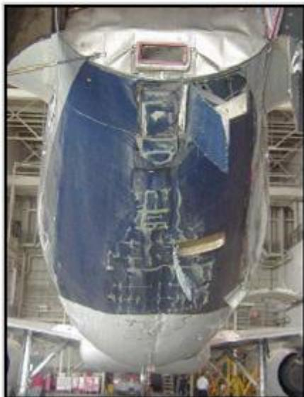
Oštećenje repa zrakoplova
