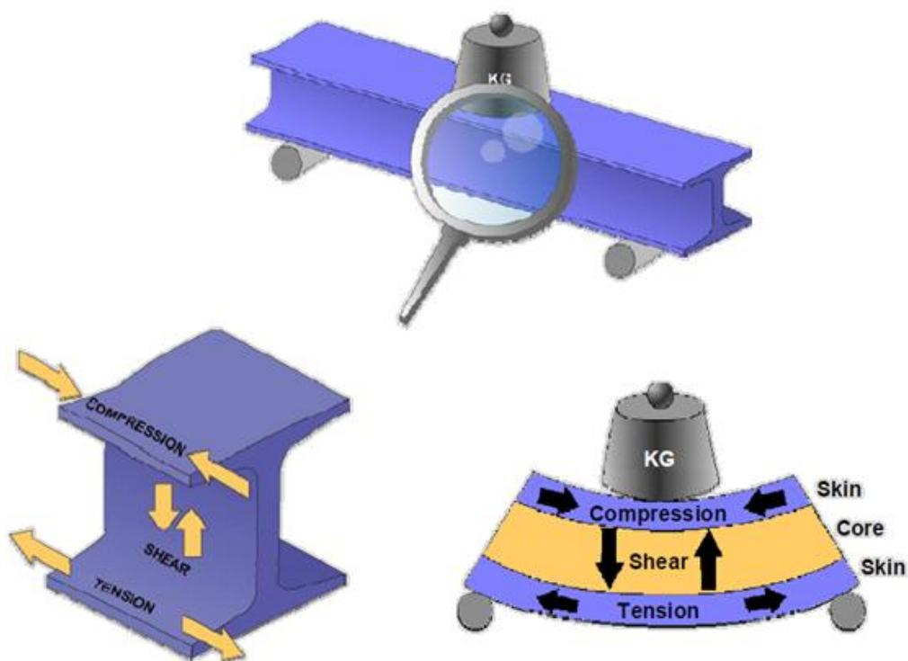
Slika 16. Ponašanje sendvič konstrukcija pod opterećenjem [3]
