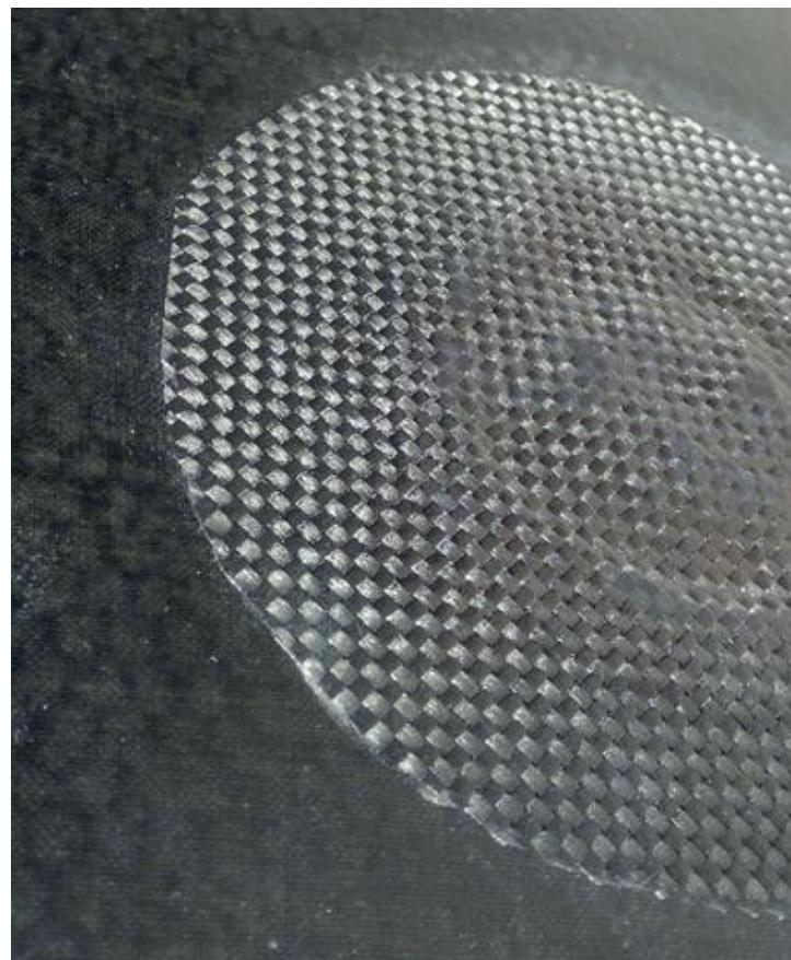
*Slika 86. Panel nakon poliranja i završne obrade*
