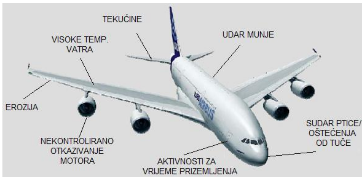
Slika 38. Uzroci oštećenja zrakoplovne konstrukcije
