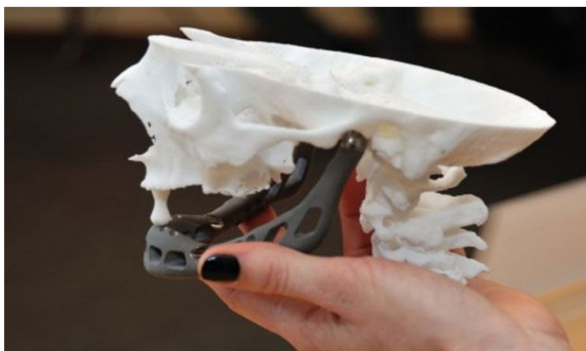
Slika 38. Prikaz isprintanih kostiju glave sa ugrađenim implantom [20]
