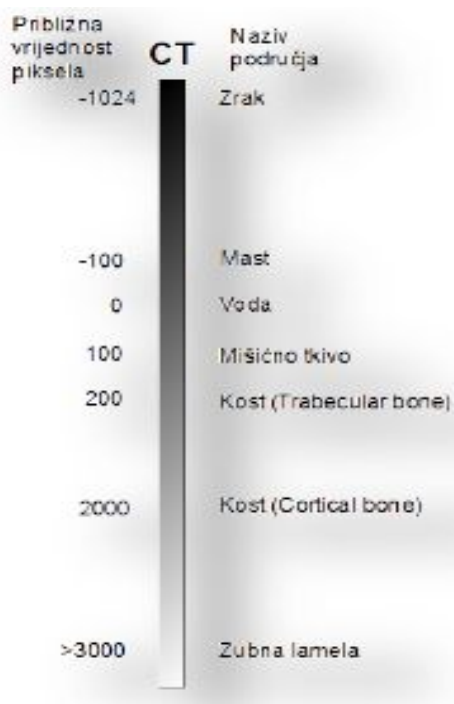
Slika 1. Prikaz vrijednosti sive skale CT-a [1]
