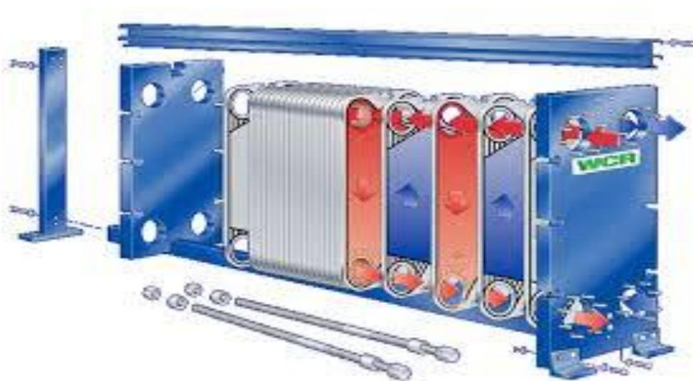
Slika 7. Okvir pločastog izmjenjivača topline
