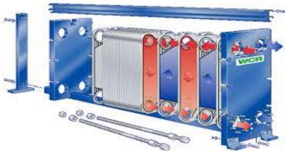
Slika 7. Okvir pločastog izmjenjivača topline
