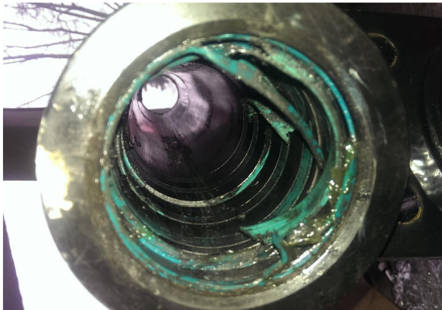
Slika 5 - Oštećenje na cilindru aktuatora
