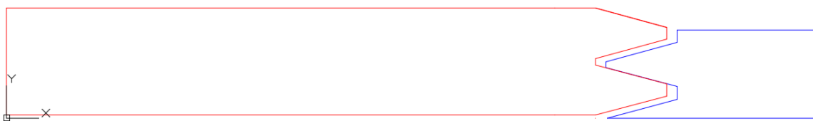
Slika 35 - 2D prikaz navoja matice i vijka (matica žuta, vijak crveni)
