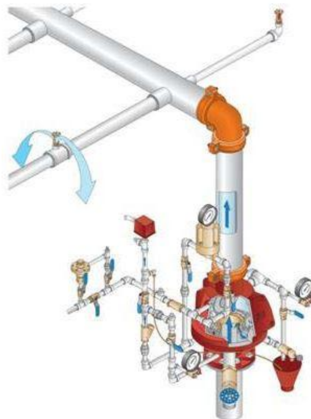
Slika 35. Predodžba shematski prikaz dijela mokrog sprinkler sustava
