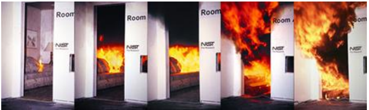
Slika 6. Predodžba faza požara do gašenja
