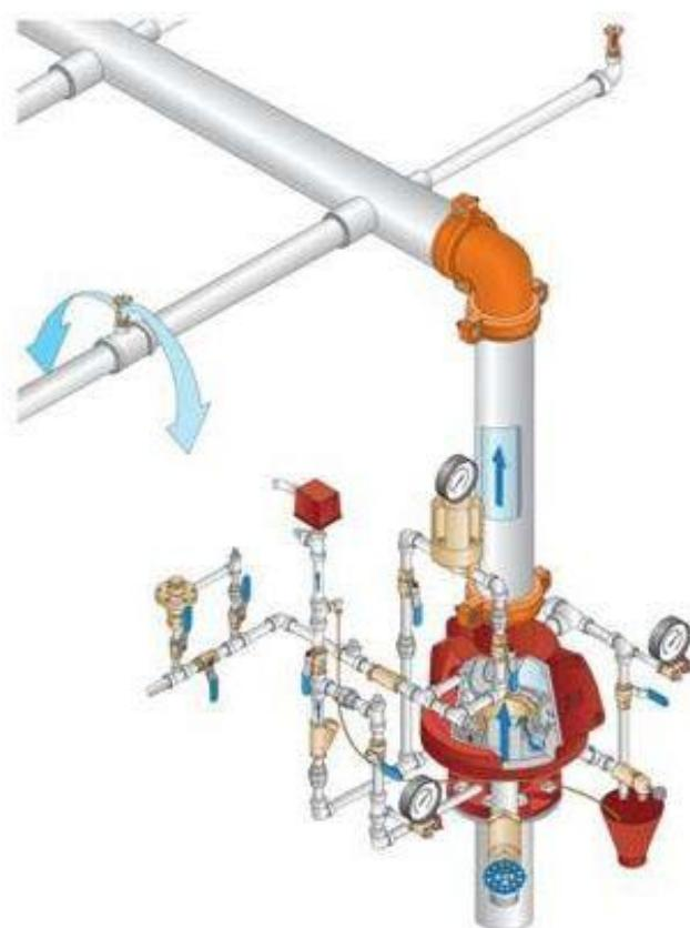
Slika 35. Predodžba shematski prikaz dijela mokrog sprinkler sustava
