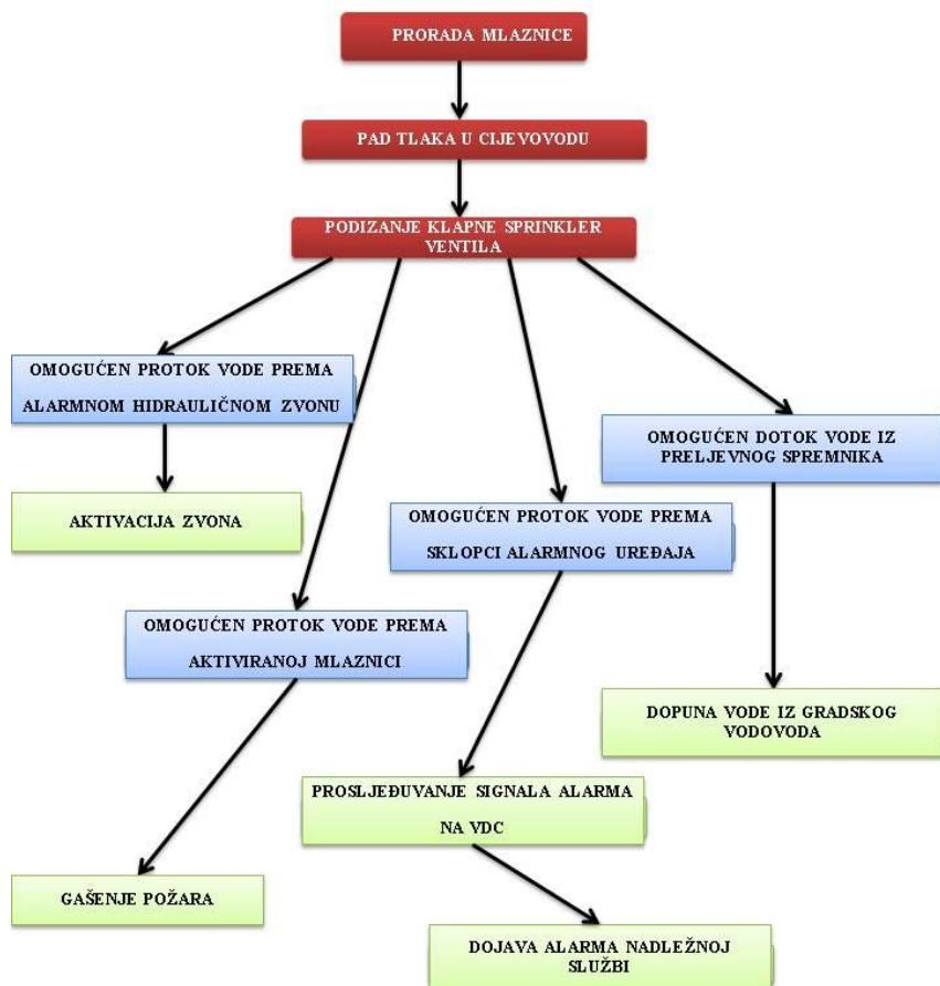
Slika 42. Predodžba algoritma rada sustava
