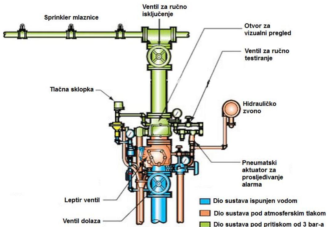
Slika 36. Predodžba dijela suhog sprinkler sustava
