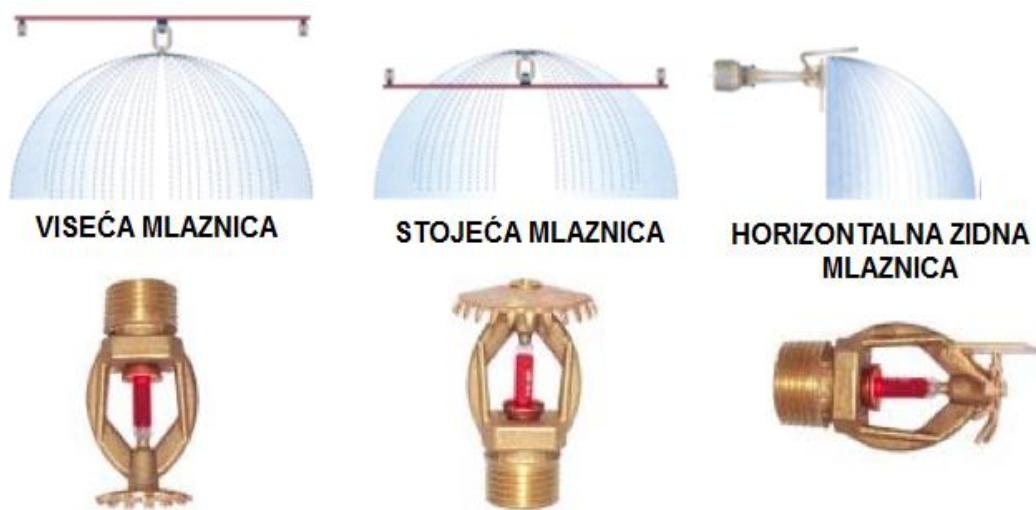
Slika 39. Predodžba različitih tipova ugradnje sprinkler mlaznica
