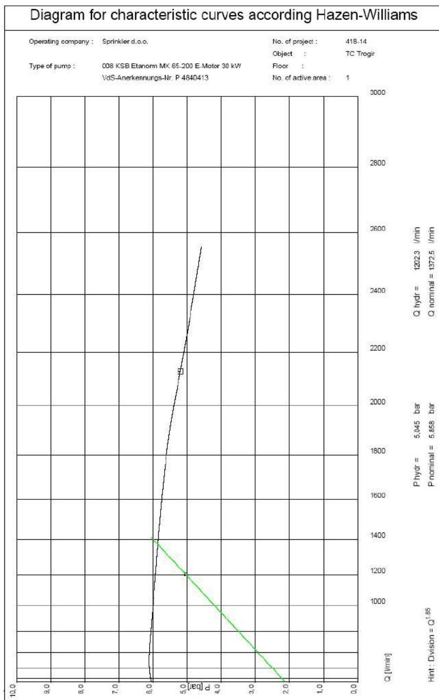
Slika 29. Predodžba Hazen – Wiliams krivulje za određivanje sprinkler pumpe
