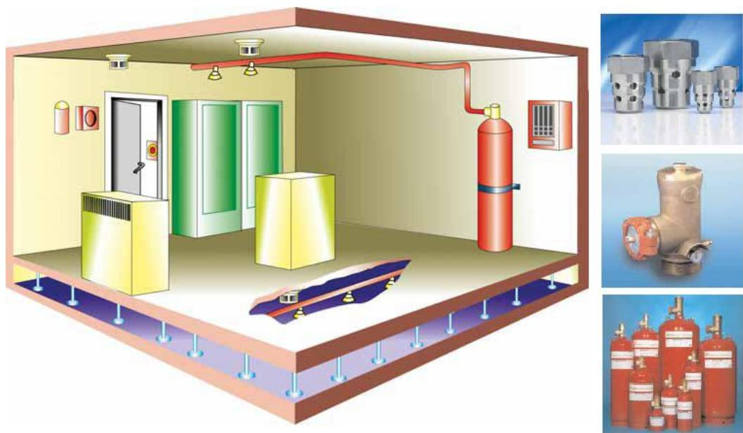
Slika 21. Predodžba shematskog prikaza sustava Novec 1230 s njegovim elementima
