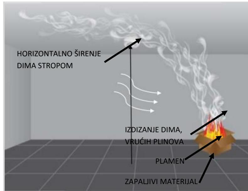
Slika 4. Predodžba razvoja požara u zatvorenoj prostoriji
