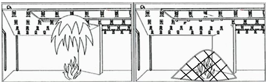
Slika 44. Predodžba idejnog rješenja poboljšanog sustava (rekacija sustava lijevo; djelovanje sustava desno)
