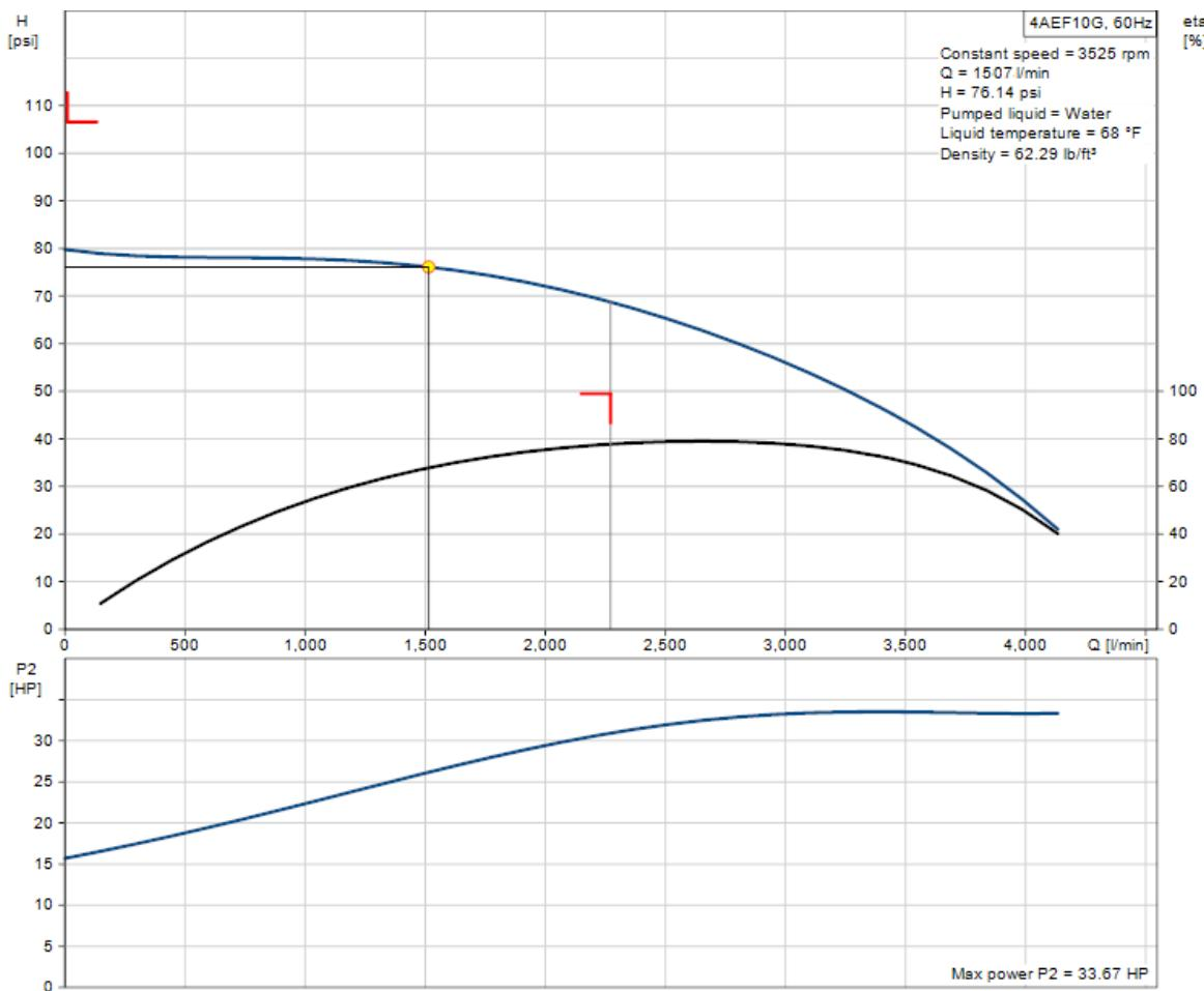
Slika 30. Predodžba krivulje sprinkler pumpe dobivena software-skim alatom
