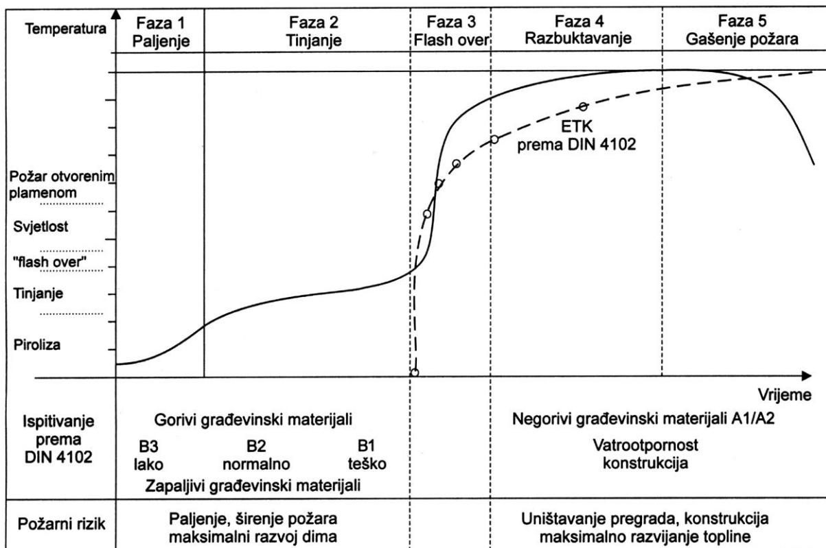
Slika 7. Predodžba shematskog prikaza tijeka požara krutih tvari
