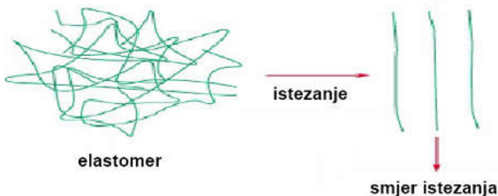
Slika 11. Shematski prikaz istezanja gume[11]
