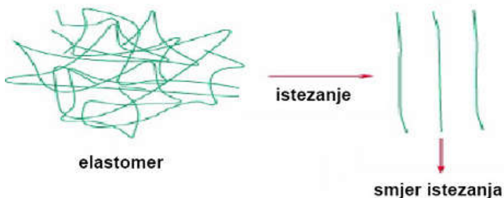
Slika 11. Shematski prikaz istezanja gume[11]
