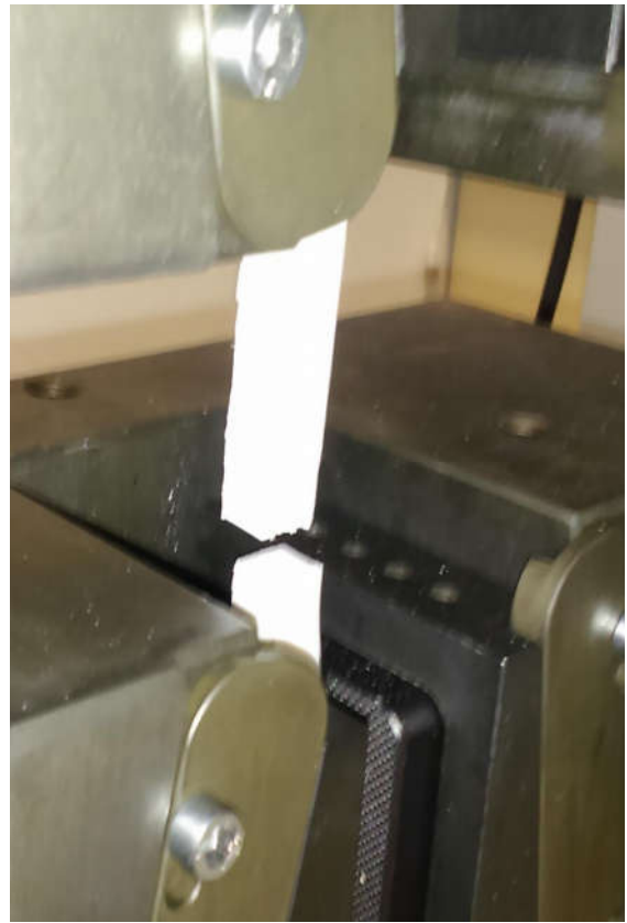
Slika 52. Epruveta nakon ispitivanja
