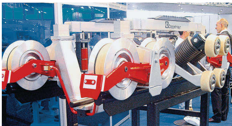
Slika 33. Kolotura za žičaru [21]
