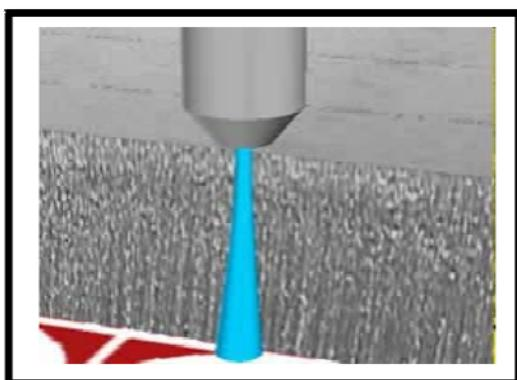
Slika 6.2. a) Visoka kvaliteta obradene površine sa malom brzinom kretanja obradka i mala produktivnost rezanja [6]
