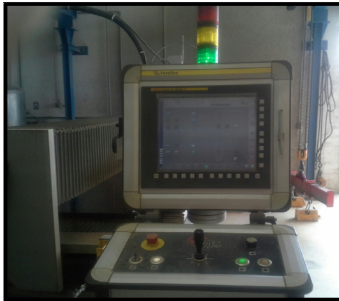
Slika 8.5. Računalni sustav stroja za vodeno rezanje
