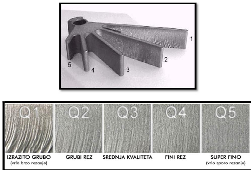
**Slika 6.5. Različite kvalitete obrađene površine abrazivnim vodenim mlazom [6]**
