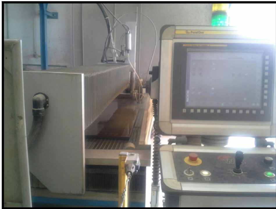
Slika 9.1. Izrezivanje prirubnica na stroju NC 3015 EB
