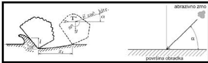
Slika 4.8. Princip odnošenja materijala abrazivnim vodenim mlazom [1]
