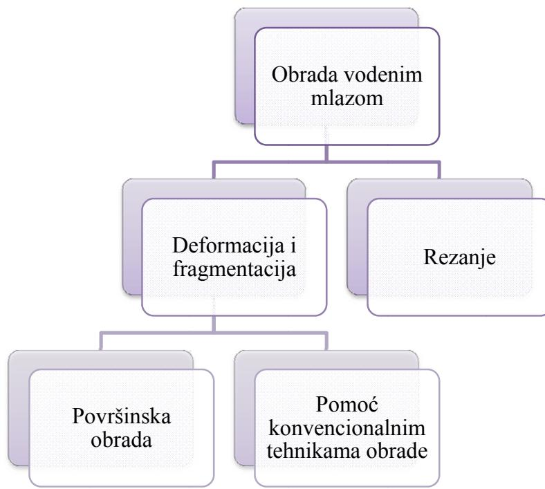
Slika 5.1. Postupci obrade materijala vodenim mlazom [8]
