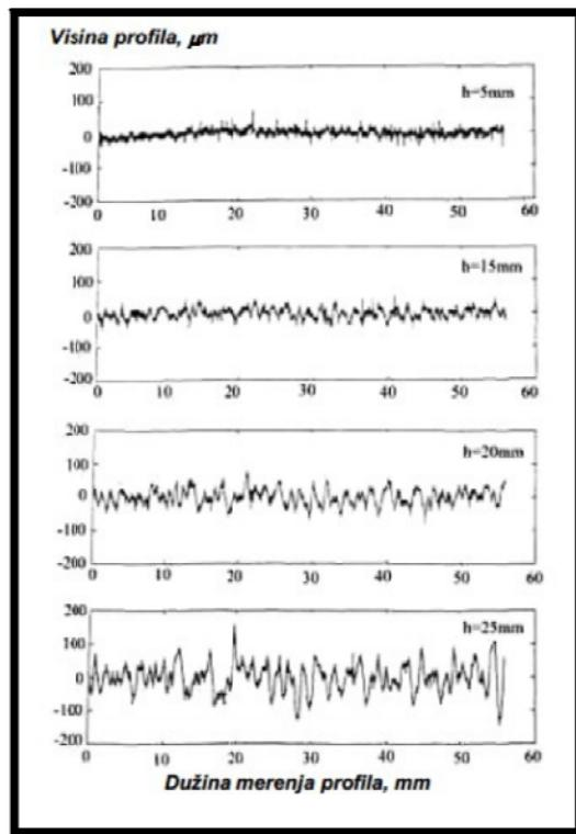
Slika 6.3. Primjeri obradene površine u ovisnosti od dubine reza  $h$  [6]
