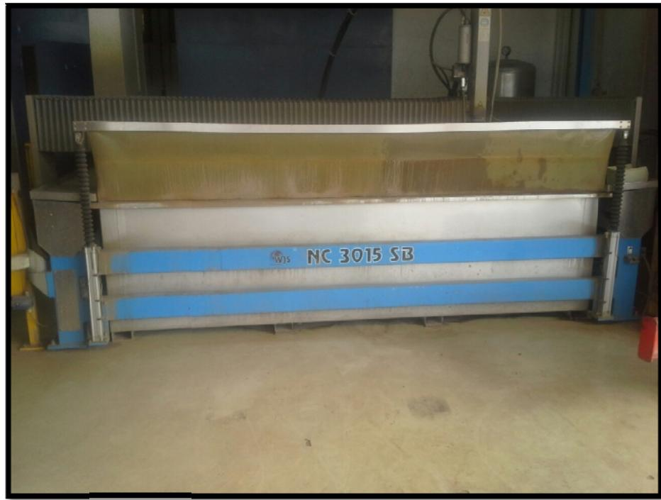
Slika 9.4. Stroj za rezanje vodenim mlazom NC 3015 EB
