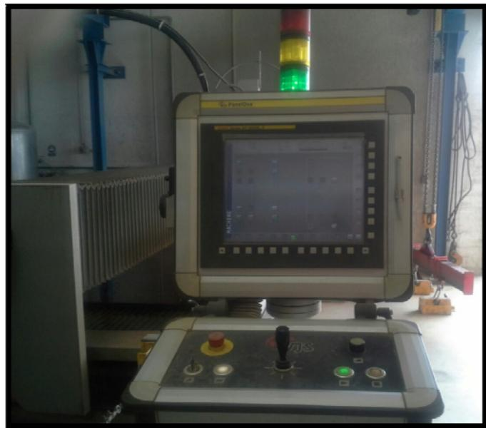
Slika 8.5. Računalni sustav stroja za vodeno rezanje
