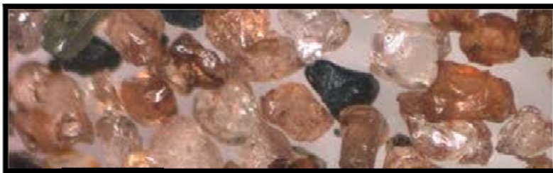
Slika 4.6. Uvećan prikaz abrazivnih čestica [12]
