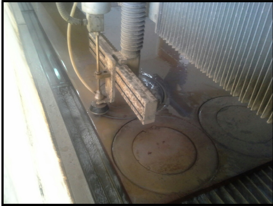
Slika 9.2. Izrezivanje prirubnica na stroju NC 3015 EB
