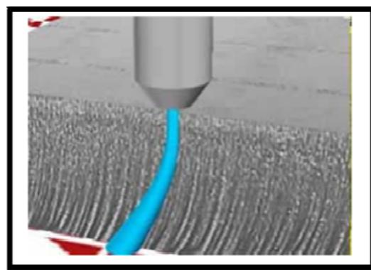
Slika 6.2. b) Niska kvaliteta obradene površine na izlasku mlaza pri velikim brzinama kretanja obradka i velika produktivnost rezanja [6]
