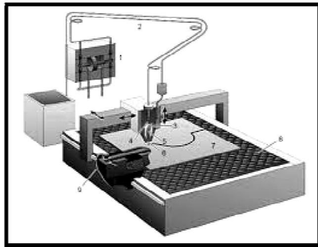
Slika 8.1. Stroj za rezanje vodenim mlazom [13]
