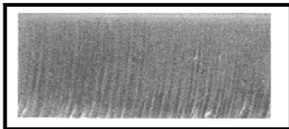
Slika 6.1. Izgled površine obradene abrazivnim vodenim mlazom [6]
