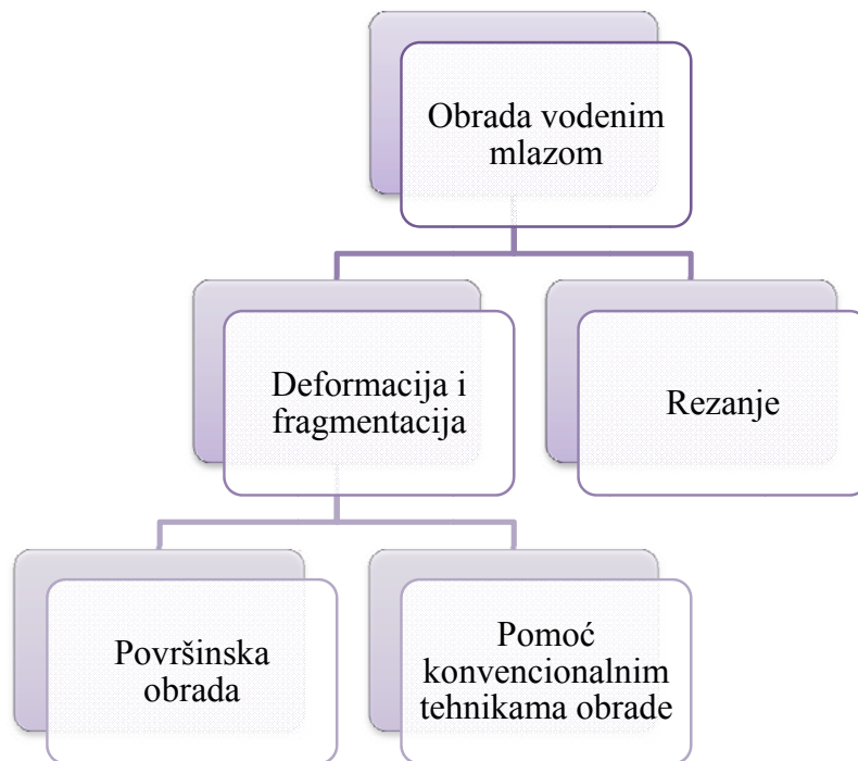
Slika 5.1. Postupci obrade materijala vodenim mlazom [8]
