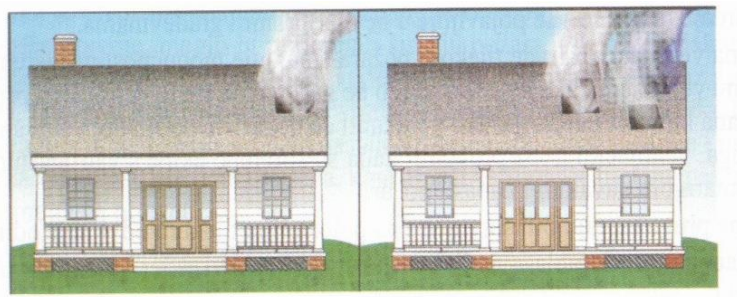
Slika 28. Ventilacijski otvori na krovu [1]
