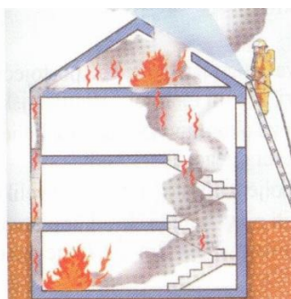
Slika 29. Usmjereni mlaz vode-brže odimljavanje i sprječavanje širenja požara [1]
