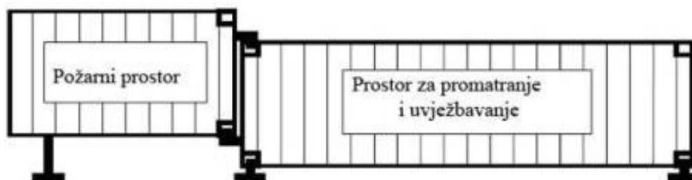
Slika 15. Dijelovi simulatora na kruta goriva [6]
