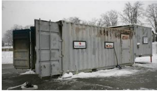
Slika 10. Prvi simulator plamenih udara u RH (JVP Karlovac 2007. godine)[6]
