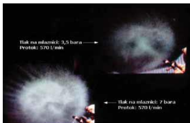
Slika 22. Odnos tlaka na mlaznici na promjer kapljica mlaza [7]
