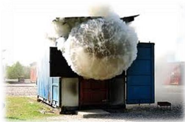
Slika 5. Backdraft stvoren u simulatoru plamenih udara [6]
