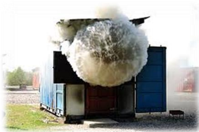
Slika 5. Backdraft stvoren u simulatoru plamenih udara [6]
