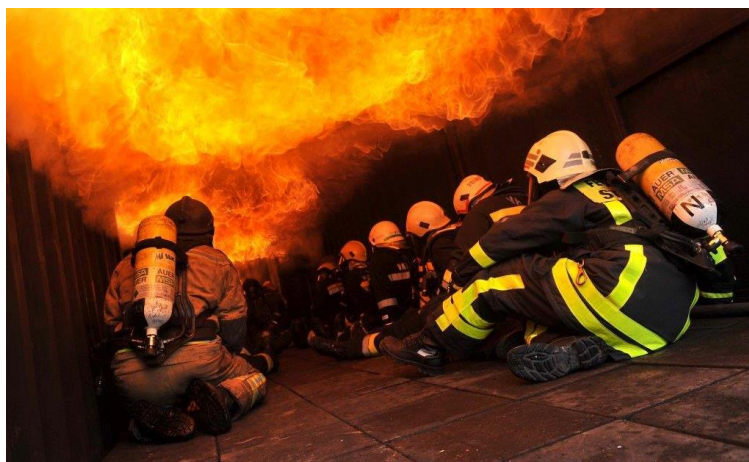
Slika 16. Flashover u simulatoru na kruta goriva [6]
