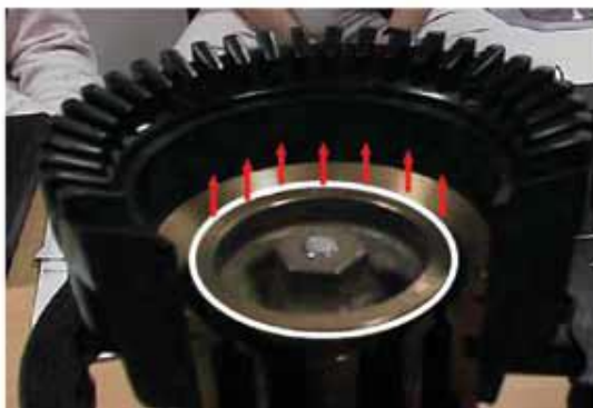
Slika 24. Brzina na čitavom opsegu mlaza je ista [7]
