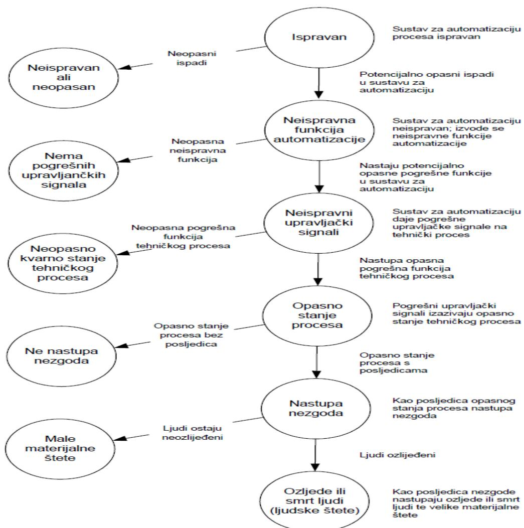
Sl. 4.2. Slijed stanja između pojave potencijalno opasnog ispada u sustavu za automatizaciju i nastanka nezgode sa štetama [7]
