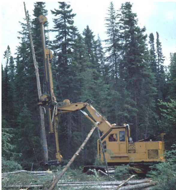
Slika 2. Beloit harvester iz 1970. godine (izvor: http://www.hankstruckpictures.com/pix/trucks/jim_falconer/2012/07-01/bowater/woods/w346.jpg 2016.)
