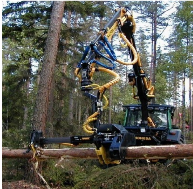
Slika 6. Harvesterska glava s taktnom tehnologijom (izvor: https://bib.irb.hr/datoteka/637955.Diplomski_rad_Krizanic.pdf 2016.)
