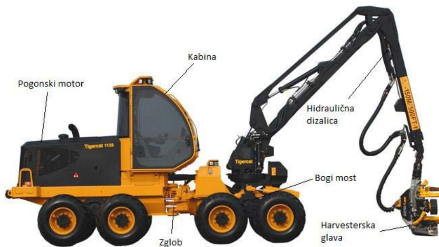
Slika 3. Glavni dijelovi harvestera (izvor: http://www.tigercat.com/products/forestry 2016.)
