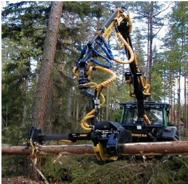
Slika 6. Harvesterska glava s taktnom tehnologijom (izvor: https://bib.irb.hr/datoteka/637955.Diplomski_rad_Krizanic.pdf 2016.)
