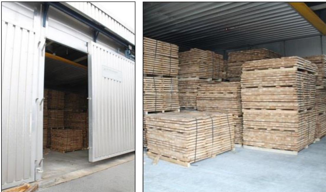
Sl. 28. Paleta složene piljene građe unutar sušare [1]
