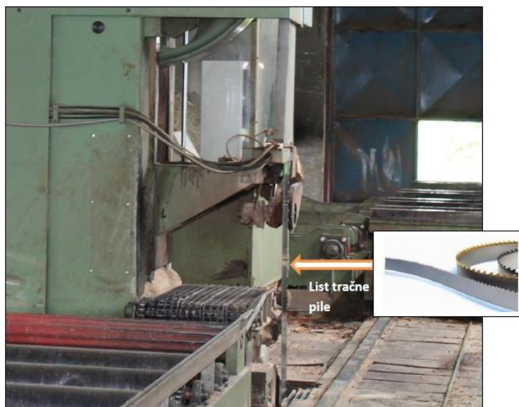
Sl. 20. Tračna pila [1]
