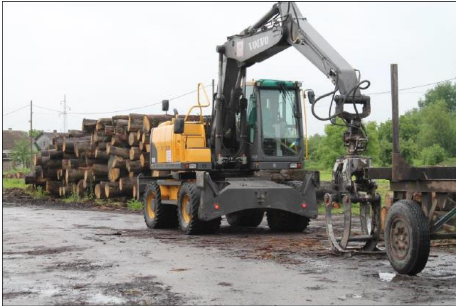
Sl. 13. Vozilo za istovar trupaca [1]
