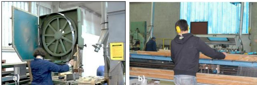
Sl. 21. Ručno podešavanje vodilice lista tračne pile (a) i ručno prinošenje drveta za obradu (b) [1]
