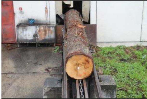
Sl. 17. Lančani transporter za transportiranje trupaca do pilane [1]
