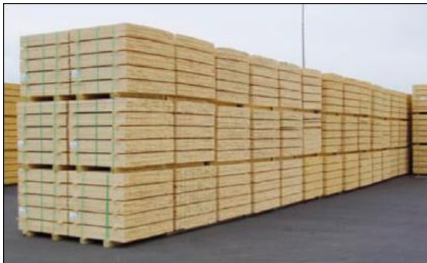
Sl. 24. Dobro složena i zapakirana drvena građa [1]
