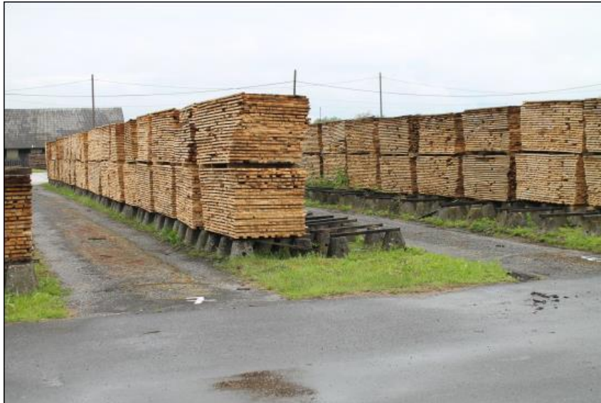
Sl. 26. Palete piljene drvene građe pristupačne utovarivaču ili viličaru [1]
