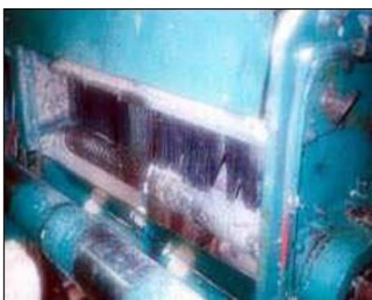
Sl. 23. Neispravan (oštećen)zaštitni uređaj za sprečavanje povratnog udarca [1] za sprečavanje povratnog udarca [1]
