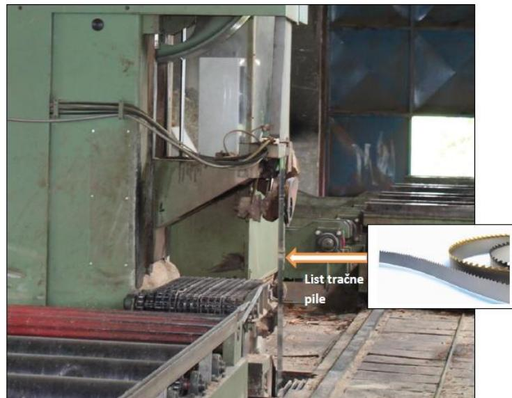
Sl. 20. Tračna pila [1]
