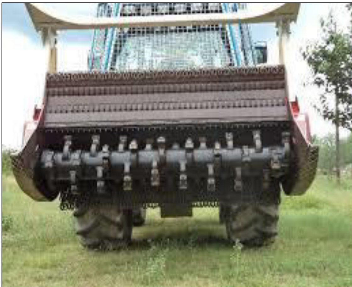
Slika 14. Traktor sa mehaničkim priključkom–sepi [Izvor. http://www.briliant.hr/rs/ ]
