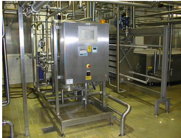
Slika 8 Linija za pasterizaciju i homogenizaciju
