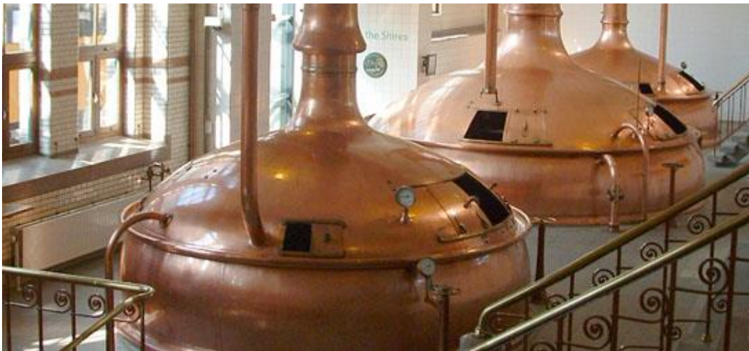
Slika 6. Kotlovi za kuhanje sladovine
