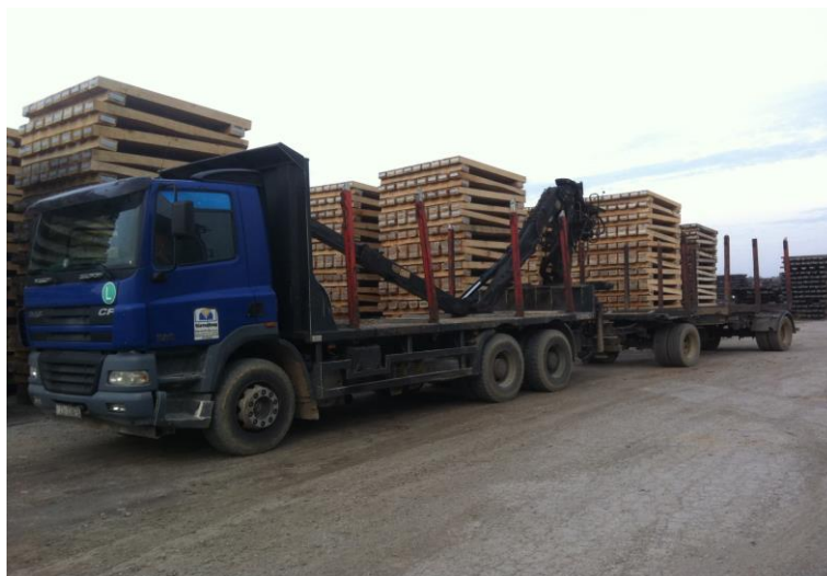
Slika 1. Vozilo za prijevoz i istovar drvnih sortimenata [1]
