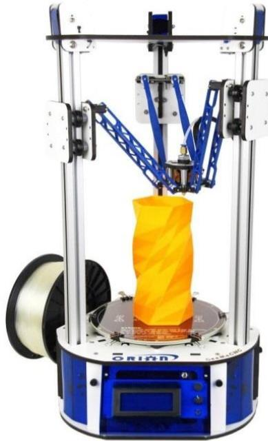
Slika 24. Način izrade modela na delta printeru [22]
