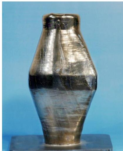
**Slika 14. Model nastao metodom elektronskog snopa sa žicom [14]**
