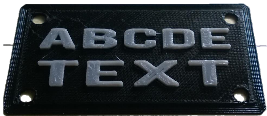
Slika 65. Mogućnost kombiniranja boja na različitim slojevima
