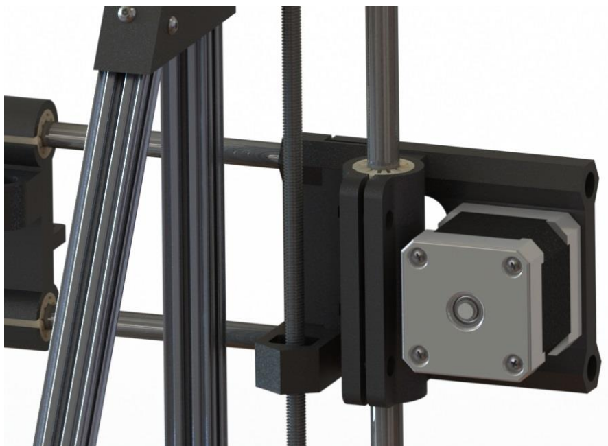
Slika 45. Način uležištenja Z-osi na dijelovima X-osi
