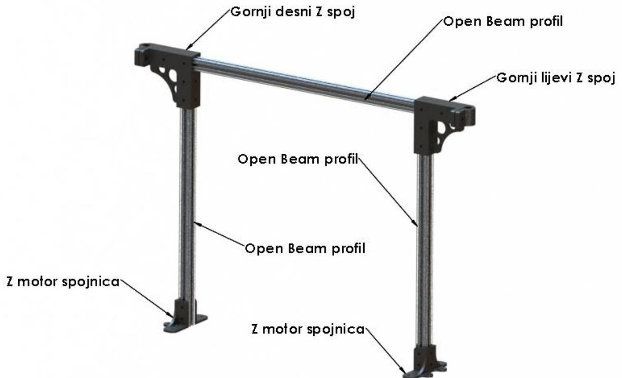
Slika 31. Sklop vertikalnog dijela noseće konstrukcije
