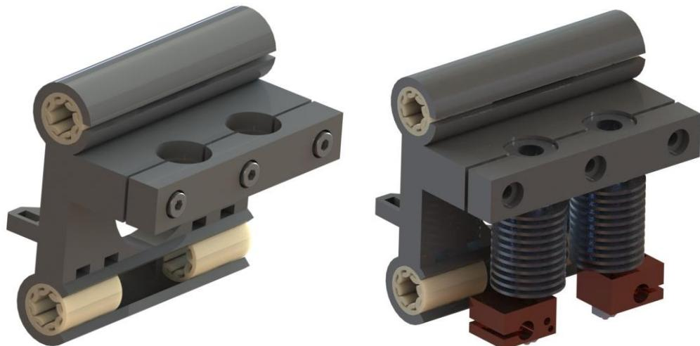
**Slika 40. Sklop nosača ekstrudera**
