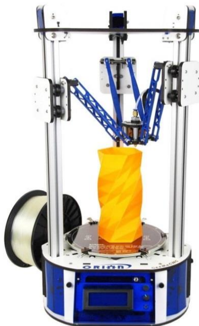
Slika 24. Način izrade modela na delta printeru [22]
