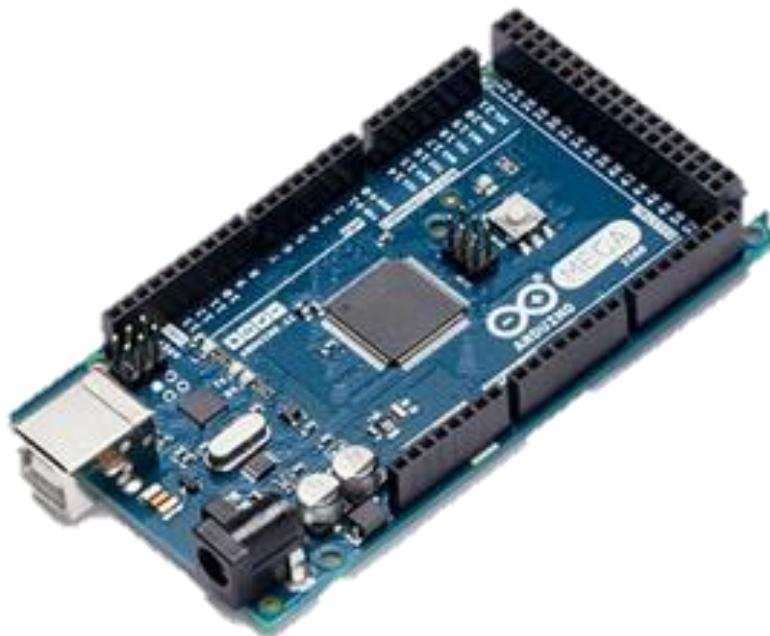
Slika 48. Arduino Mega 2560 modul [27]
