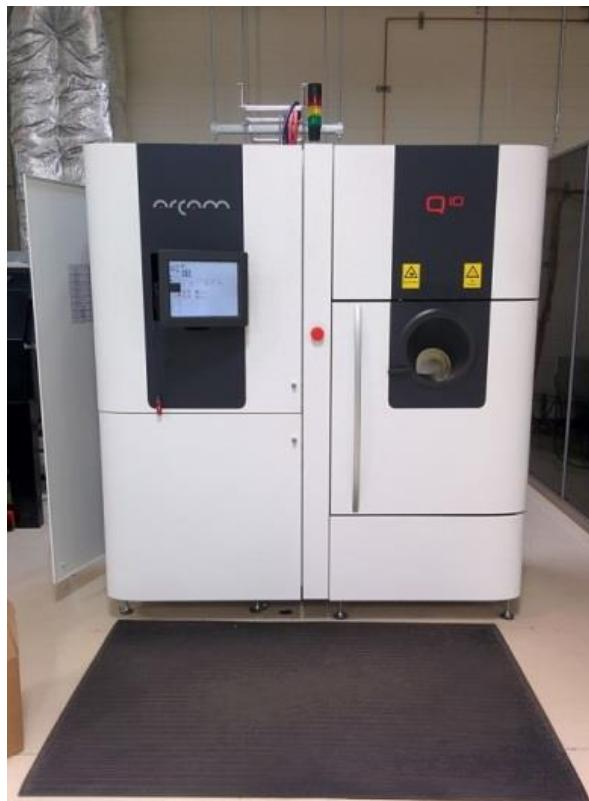
**Slika 12.** Arcam Q10 3D printer sa elektronskim snopom [12]
