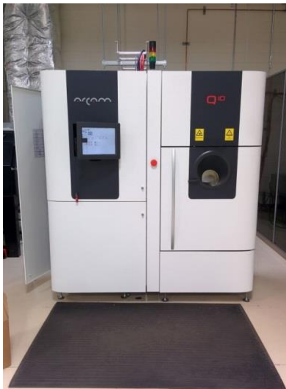
Slika 12. Arcam Q10 3D printer sa elektronskim snopom [12]
