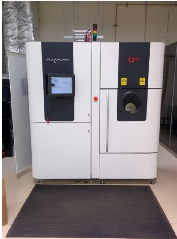
Slika 12. Arcam Q10 3D printer sa elektronskim snopom [12]
