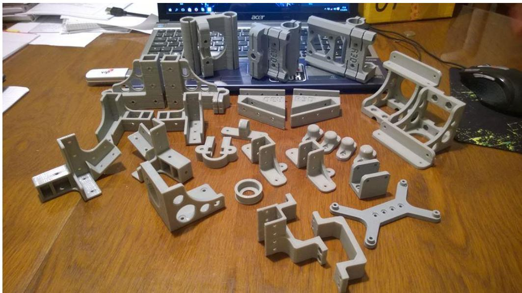
Slika 29. Svi 3D printani dijelovi potrebni za sastavljanje printer-a
