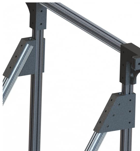
Slika 34. Način učvršćenja dijagonalnih vezivnih profila
