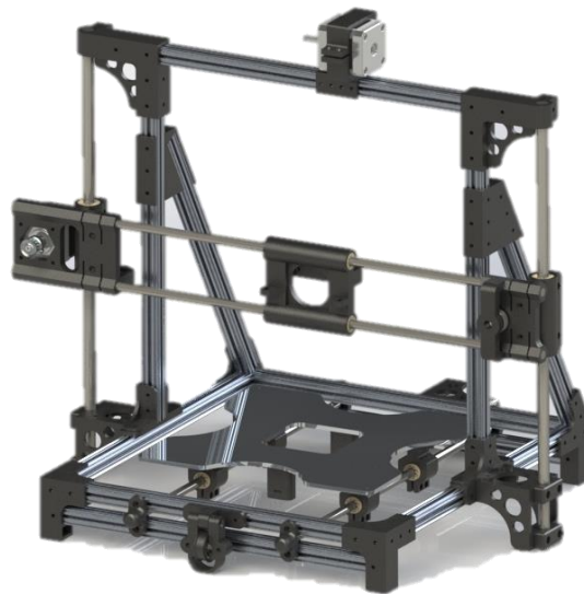
Slika 22. Printer koji radi prema Kartezijevom principu
