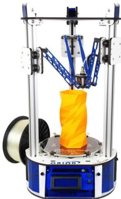
Slika 24. Način izrade modela na delta printeru [22]
