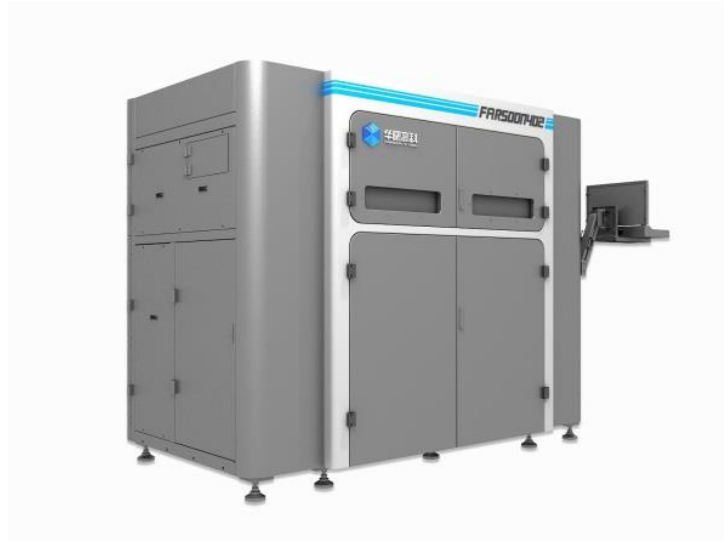
Slika 10. SLS 3D printer Farsoon 402 [10]
