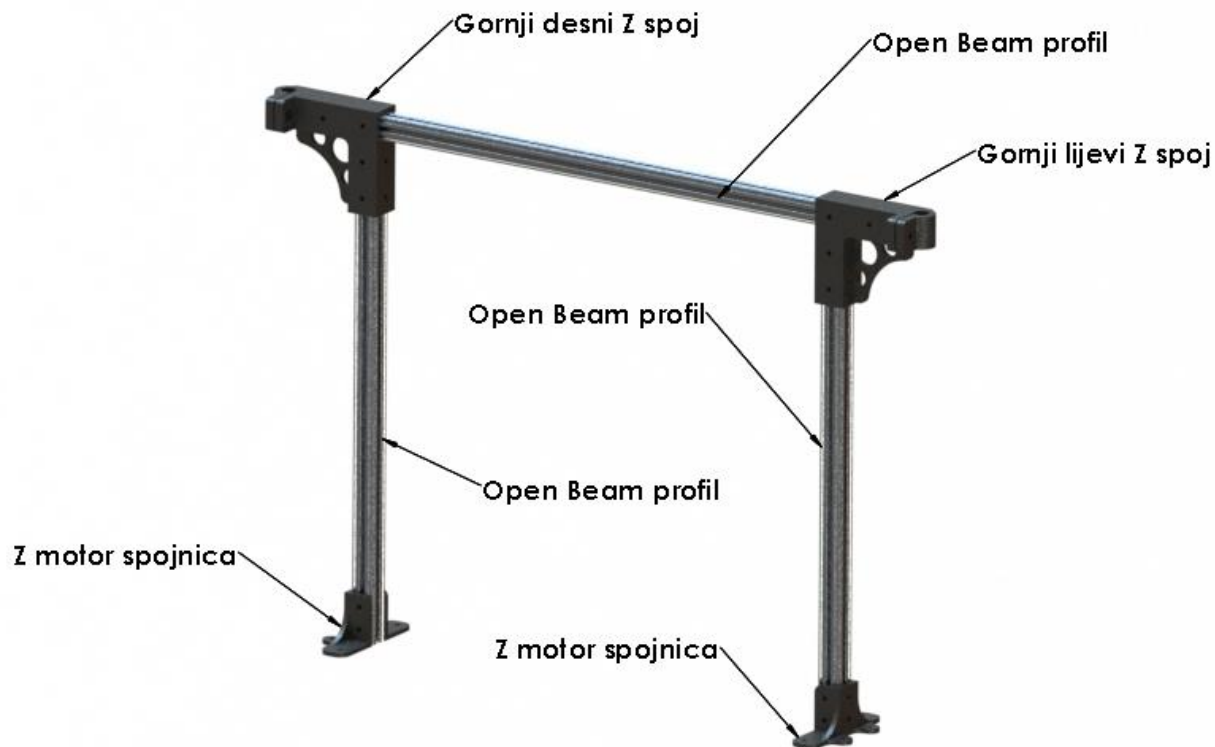
Slika 31. Sklop vertikalnog dijela noseće konstrukcije
