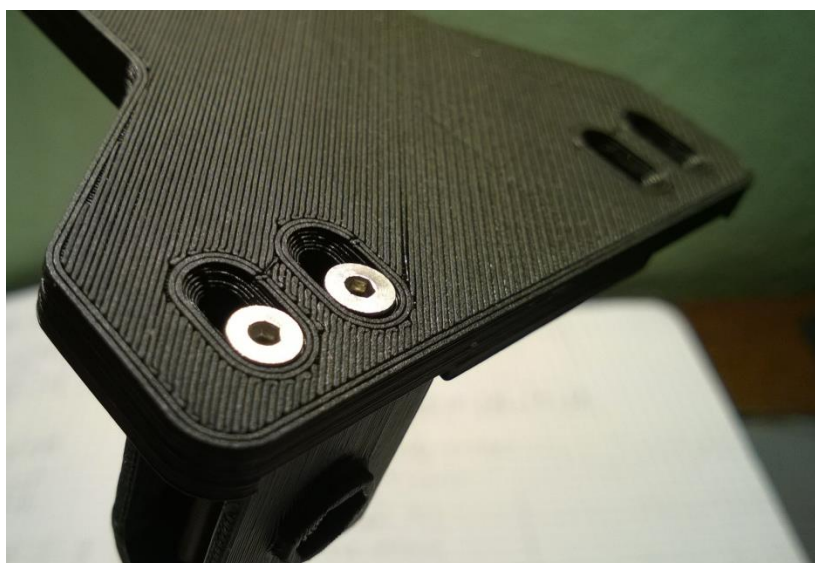
Slika 64. Skošenje za prihvat glave vijka
