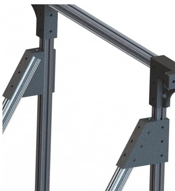
**Slika 34. Način učvršćenja dijagonalnih vezivnih profila**
