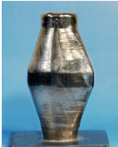
Slika 14. Model nastao metodom elektronskog snopa sa žicom [14]
