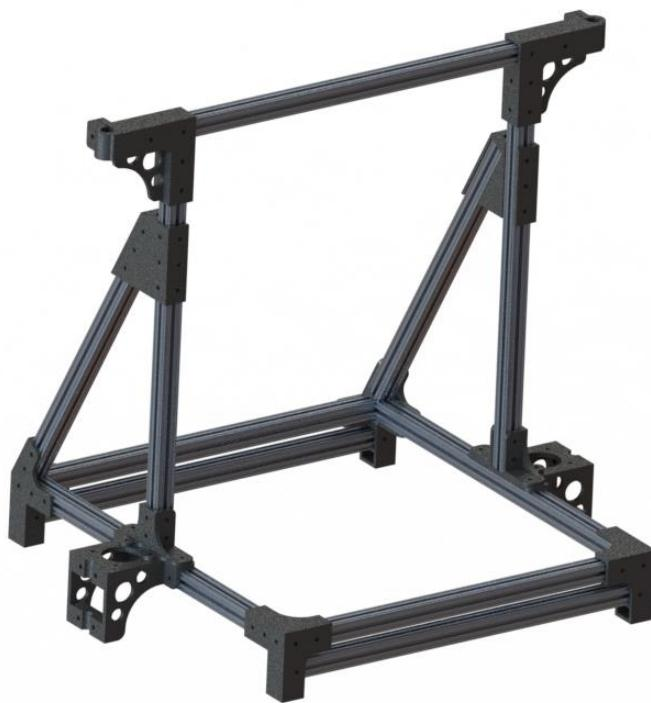
**Slika 33. Sklop cijelokupne konstrukcije 3D printera**
