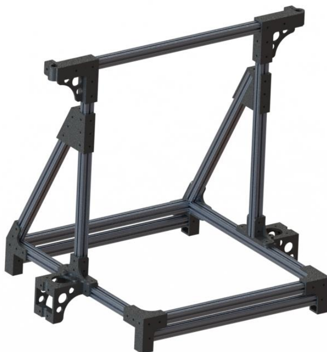
Slika 33. Sklop cjelokupne konstrukcije 3D printera
