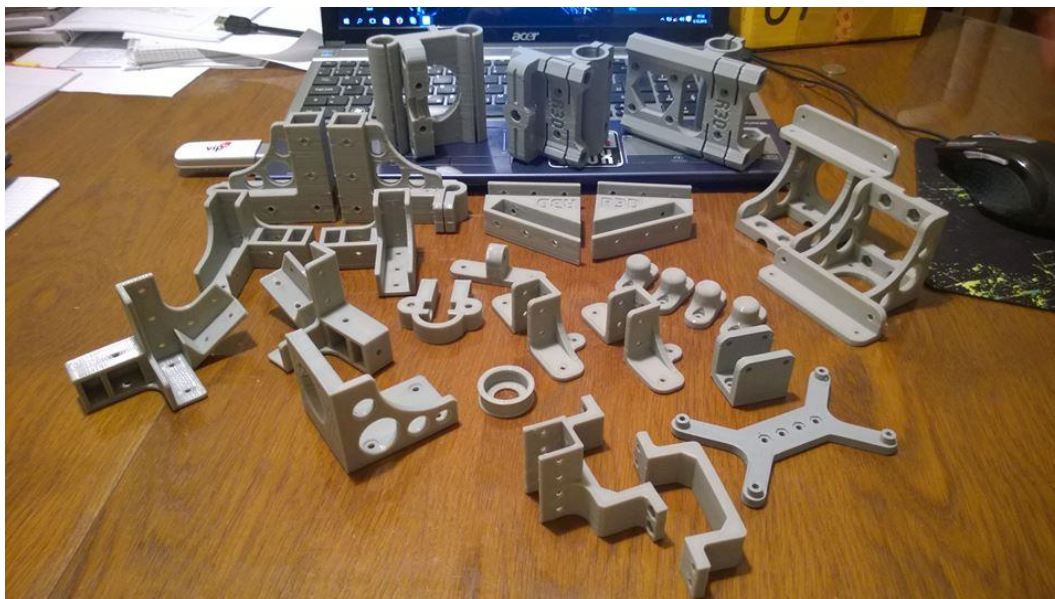
Slika 29. Svi 3D printani dijelovi potrebni za sastavljanje printera
