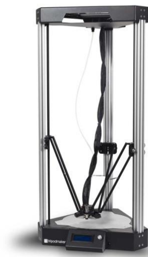
Slika 23. Model delta printera [21]
