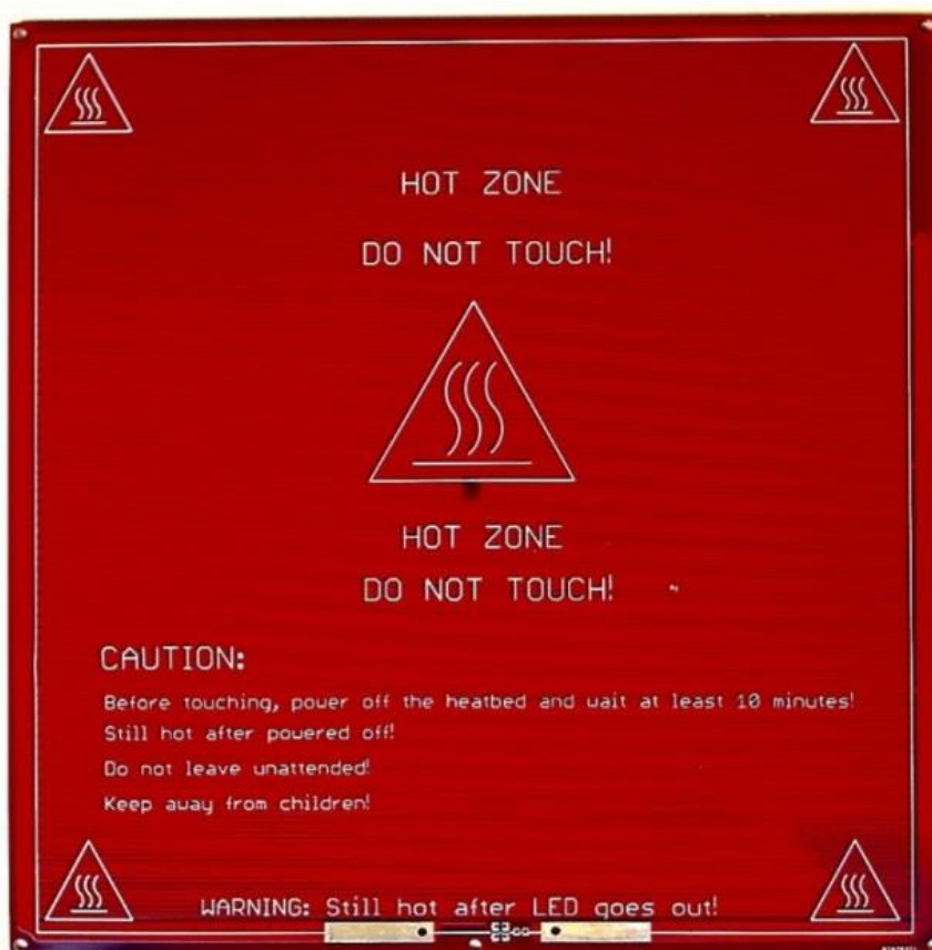
Slika 51. Grijana radna ploča [30]
