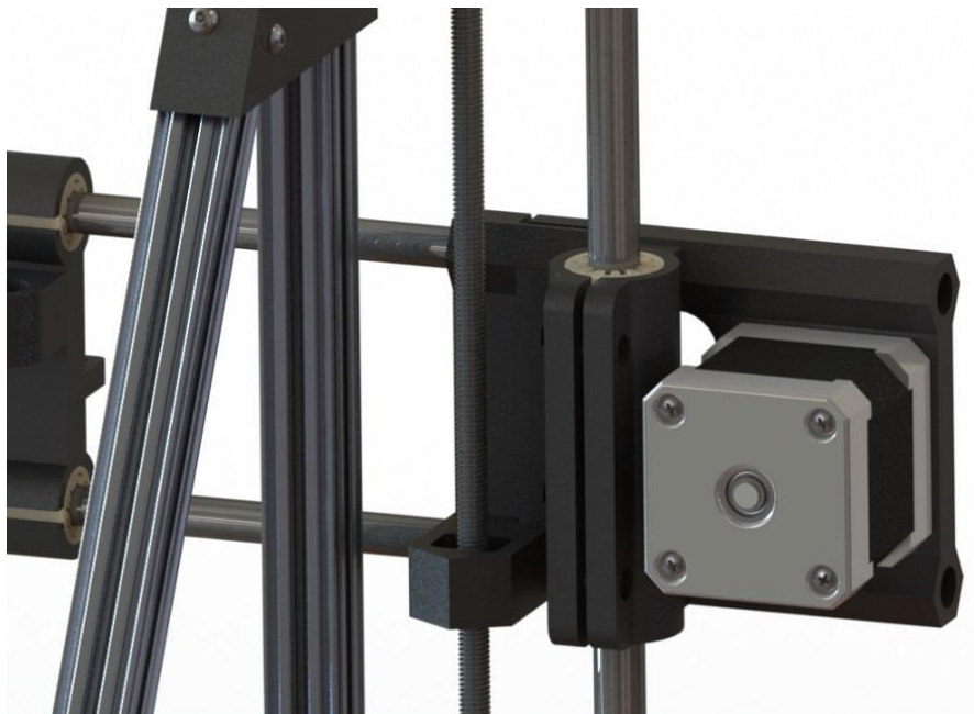
Slika 45. Način uležištenja Z-osi na dijelovima X-osi
