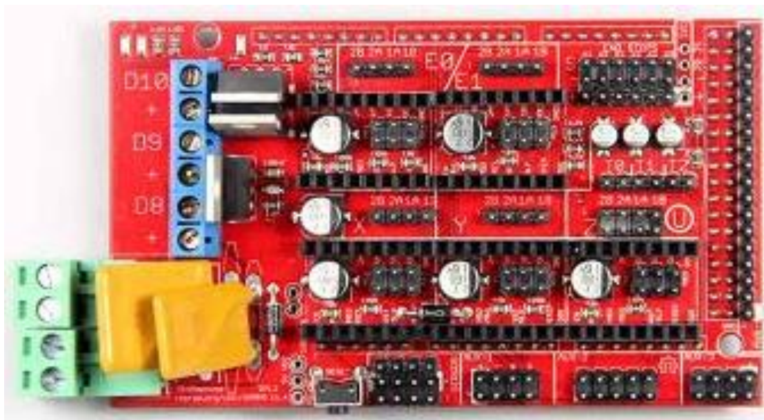
Slika 49. RAMPS kontrolna ploča [28]
