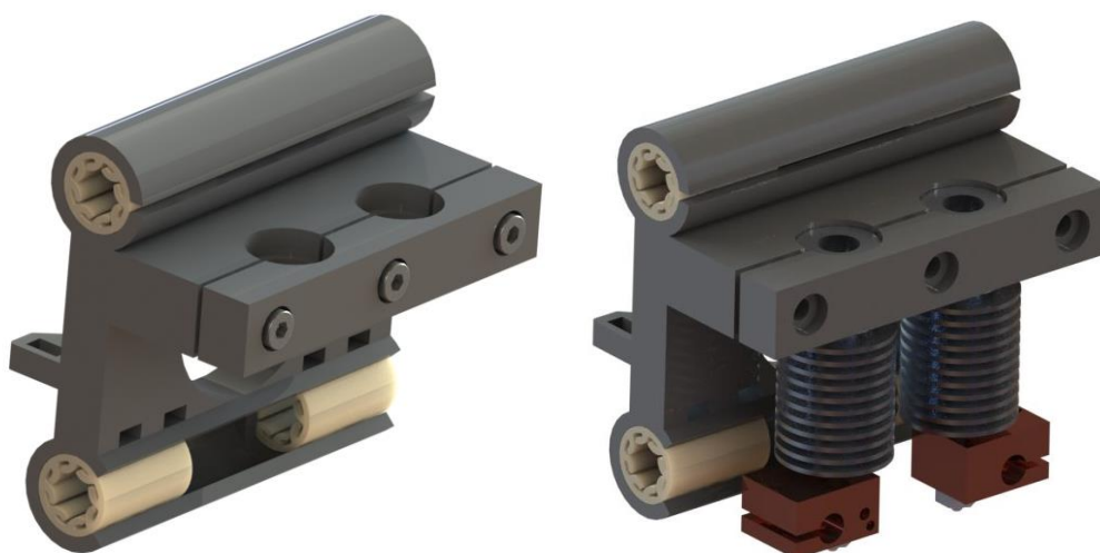
Slika 40. Sklop nosača ekstrudera
