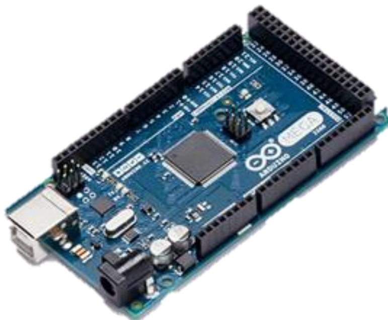
Slika 48. Arduino Mega 2560 modul [27]
