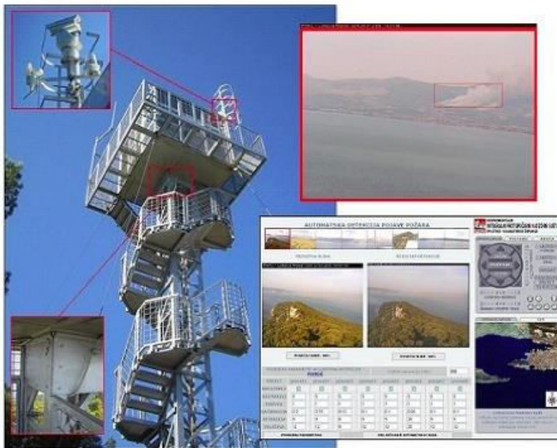
Sl. 15. Motrilačka jedinica i korisničko sučelje eksperimentalne verzije sustava IPNAS postavljene na brdu Marjan pokraj Splita 2005.g. [2]
