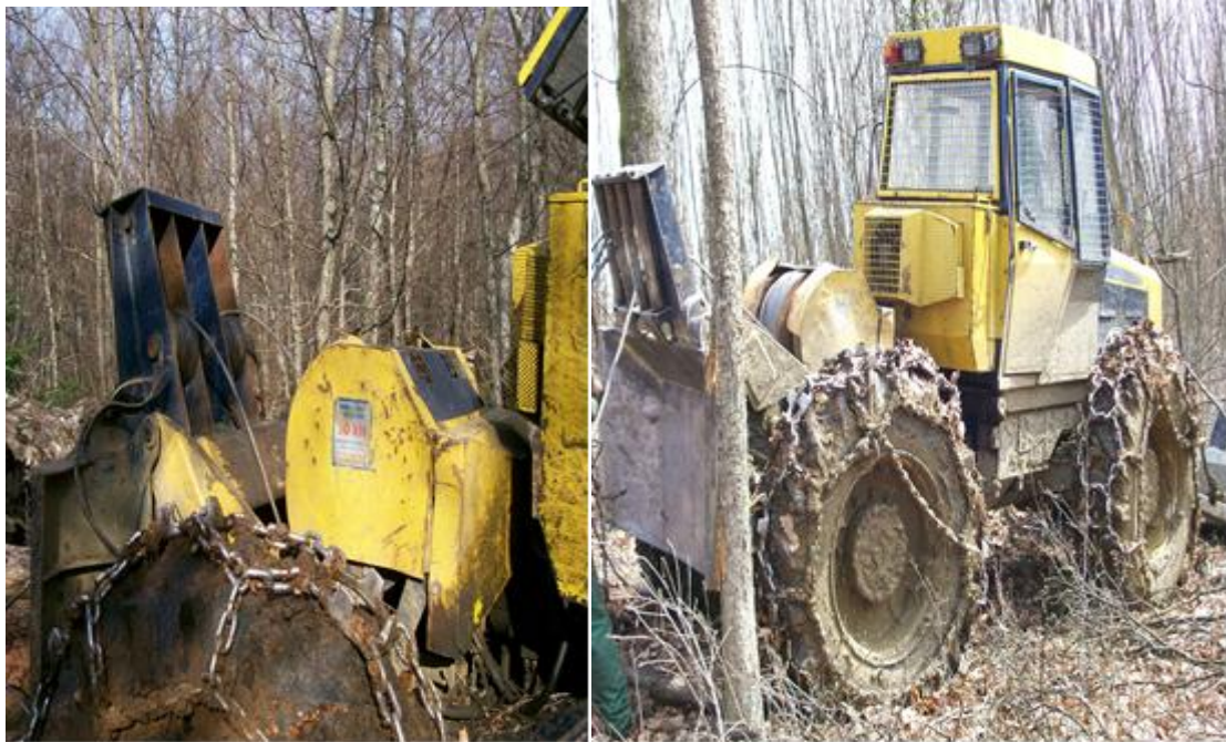
Slika 22. Detalji vitla i zaštitnih mreža na staklima šumskog zglobnog traktora
