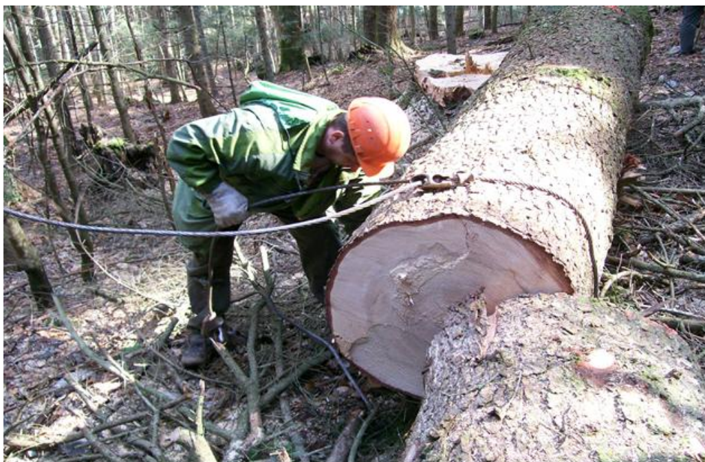
Slika 24. Prikaz ispravnog kopčanja drvnih sortimenata
