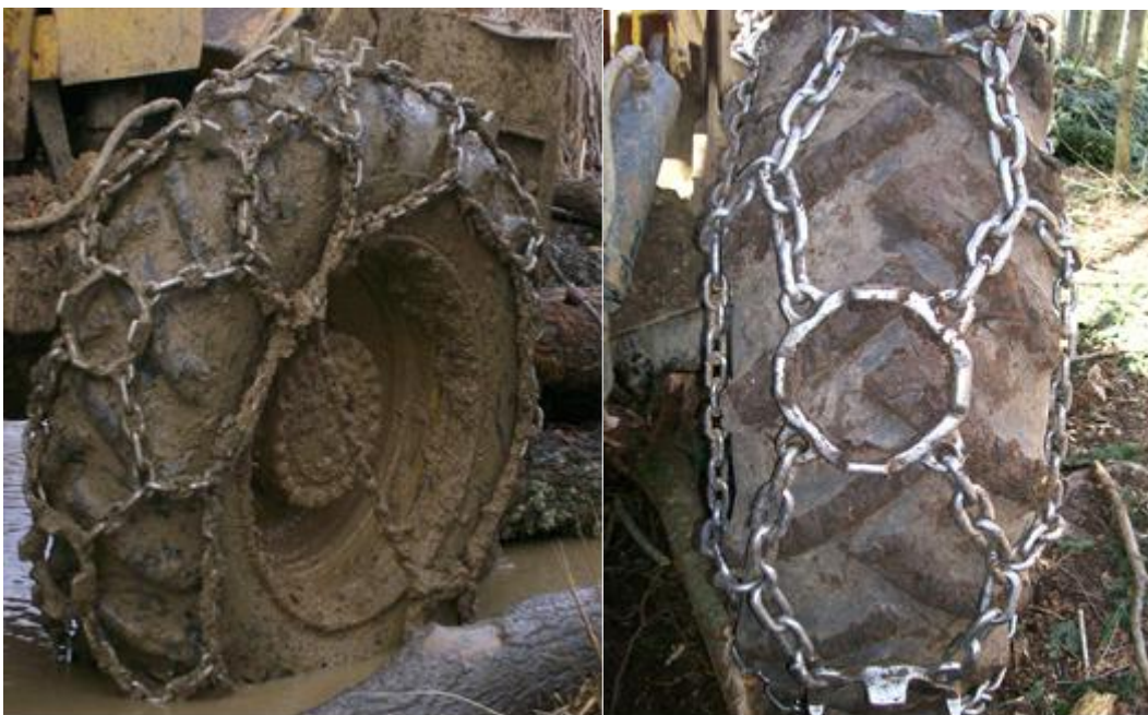
Slika 25. Guma traktora s postavljenim lancima
