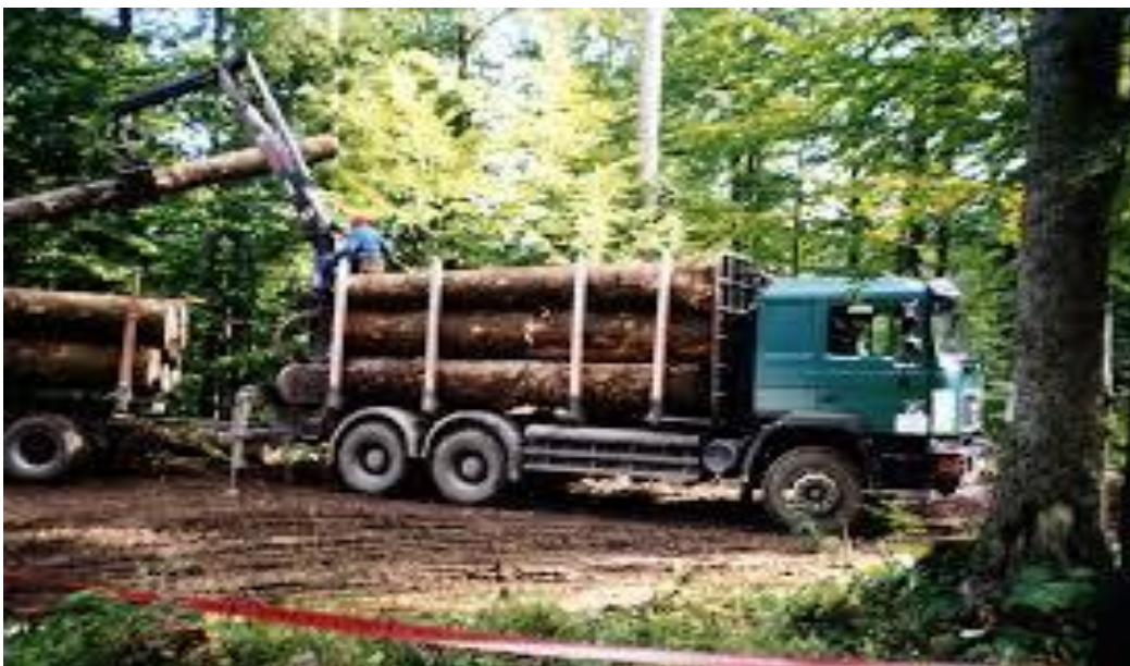
Slika 13. Prikaz hidrauličke dizalice i ispravno utovarenih drvnih sortimenata na vozilo
