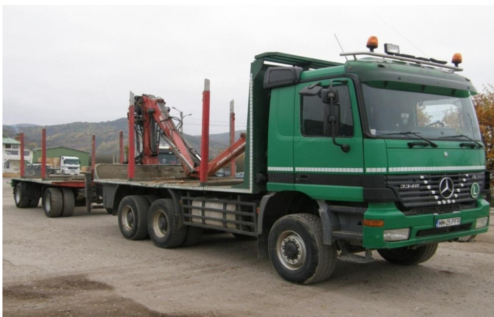
Slika 27. Prikaz hidrauličke dizalice i vozila za prijevoz drvnih sortimenata
