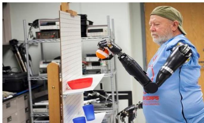
Slika 11. Upravljanje robotskom rukom samo pomoću razmišljanja
