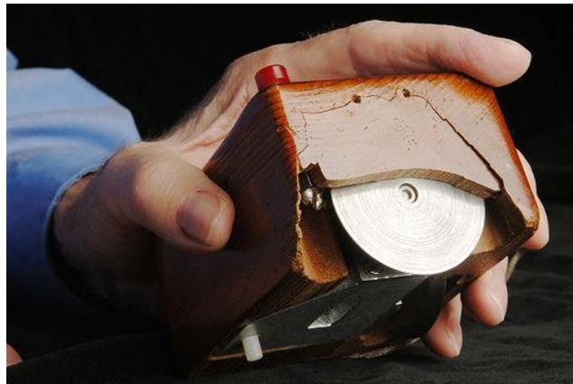
Slika 5. Prototip računalnog miša [16.]
