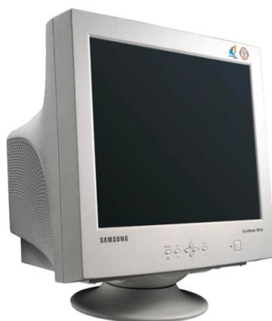
Slika 4. Računalni monitor zasnovan na katodnoj cijevi [15.]
