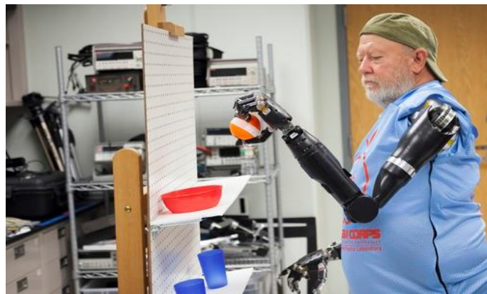
Slika 11. Upravljanje robotskom rukom samo pomoću razmišljanja
