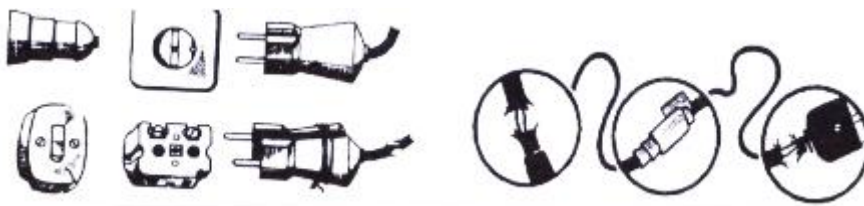
Slika 7. Neispravne utikačne naprave i električni vodovi
