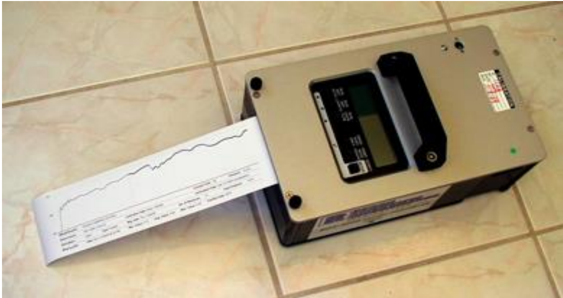
Slika 13. Prikaz tribometra vrste BOT - 3000.
