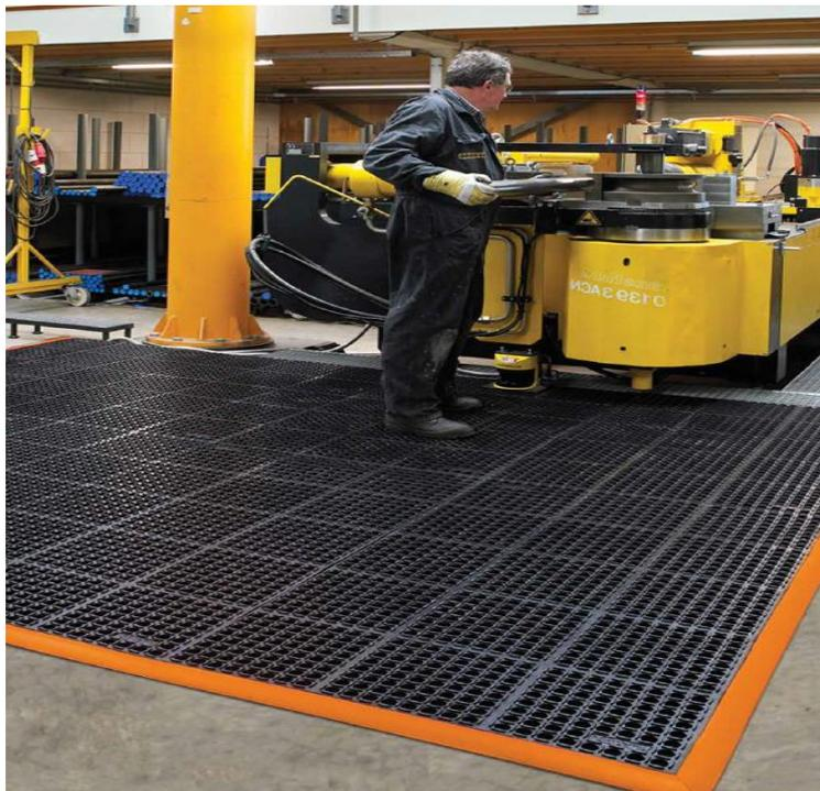
Slika 17. Protuklizna gumena podloga s interlock međusobnim povezivanjem.
