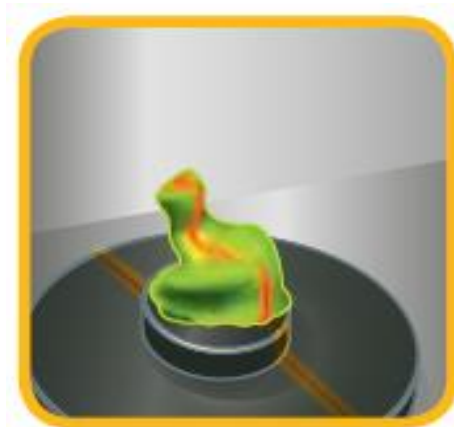
Slika 19. Lasersko skeniranje uzetog uzorka otiska [19].
