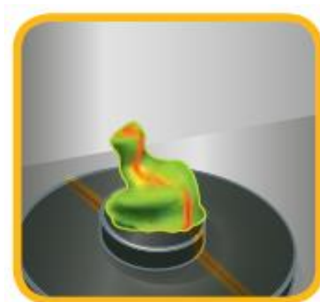
Slika 19. Lasersko skeniranje uzetog uzorka otiska [19].
