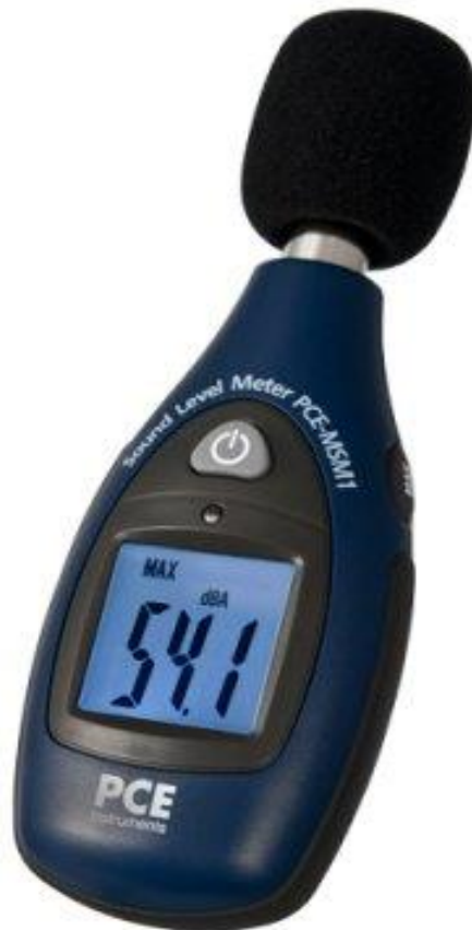
Slika 3. Uređaj za mjerenje buke [3].
