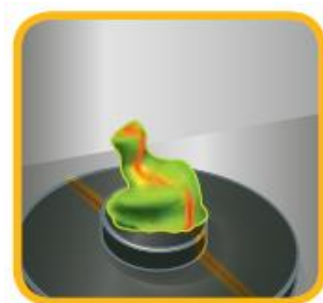
Slika 19. Lasersko skeniranje uzetog uzorka otiska [19].
