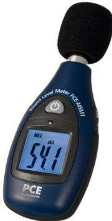
Slika 3. Uređaj za mjerenje buke [3].
